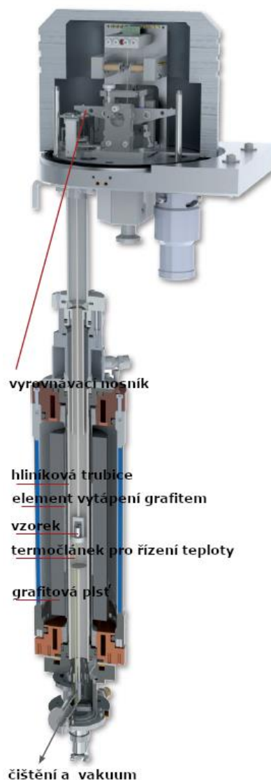
Obrázek 13. Průřez přístrojem [21]
