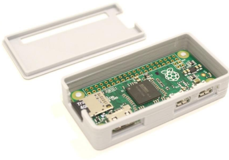
Obrázek 10: Krabička pro Raspberry Pi Zero vyráběna firmou Adafruit na FFF 3D tiskárnách [27]
