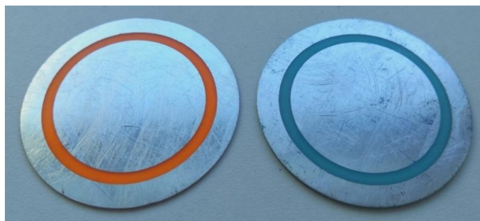
Obrázek 24: Vzorky s napařenými elektrodami pro měření rezistivity
