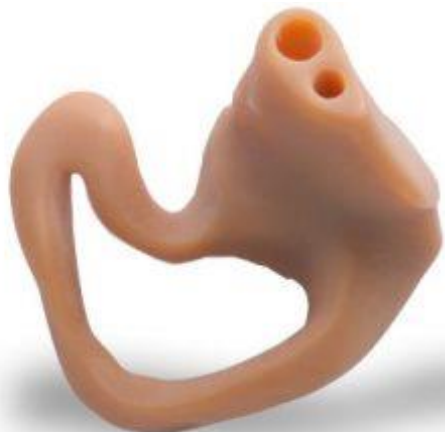
Obrázek 18: Konstrukce naslouchátka vytištěná na SLA tiskárně [43]
