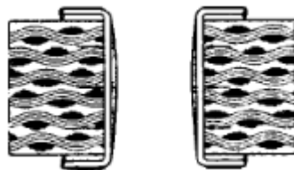
Obrázek 5: Typický vzhled pokoveného otvoru s HALem [7]
