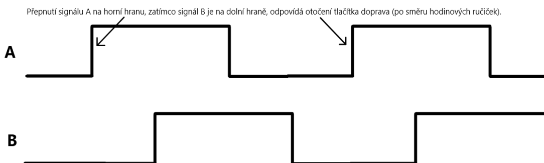
Obr. 3.8: Ideální průběh signálů A, B při otáčení doprava [vlastní zpracování podle 1]
