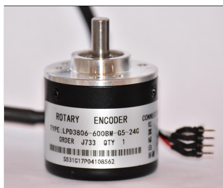
Obr. 10 Fotografie použitého rotačního enkodéru LPD3806[8]
