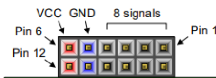
Obrázek 2.5: Nexys 4 - Port PMOD piny
