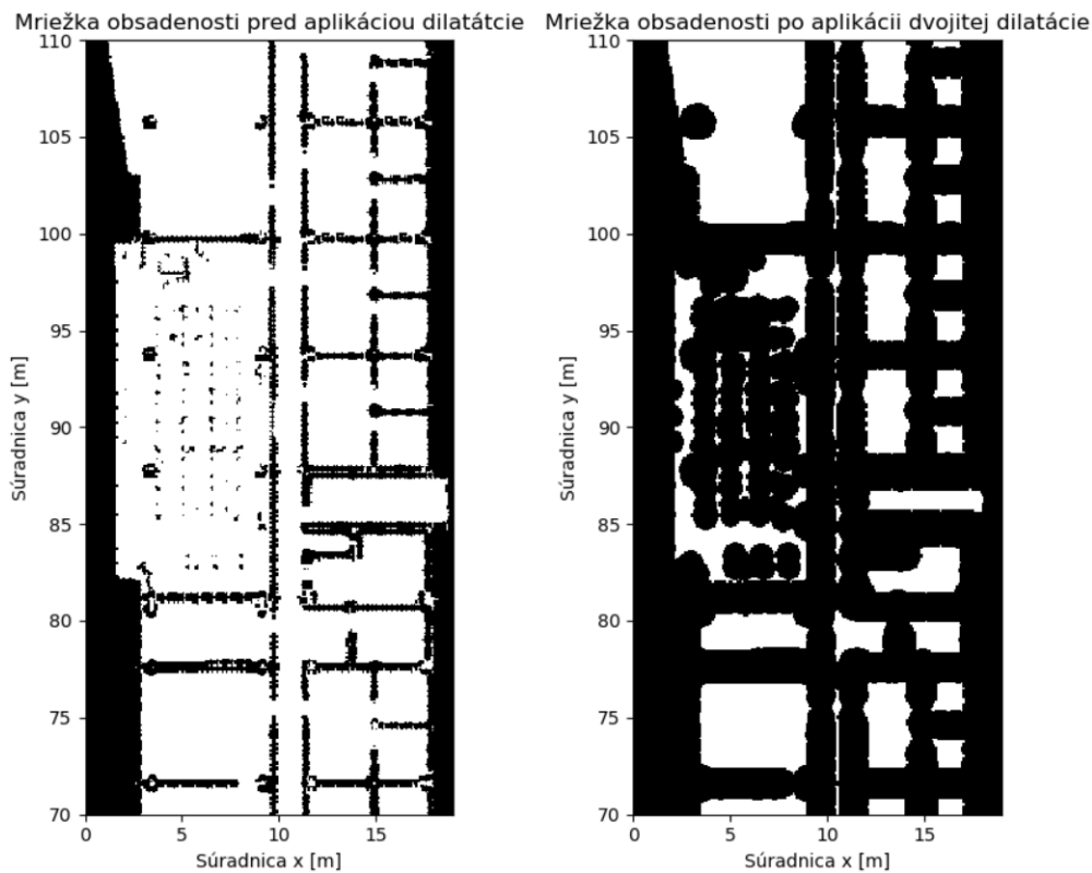
Obrázok 6.5: Naľavo je zobrazená mriežka obsadenosti pred aplikáciou dvojitej binárnej dilatácie. Napravo je mriežka obsadenosti po aplikácii dvojitej binárnej dilatácie (výšek medzi 70 m - 110 m).
