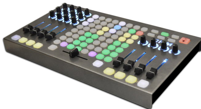
Obrázek 1.1: MIDI ovladač s tlačítky, posuvníky a otočnými ovladači
