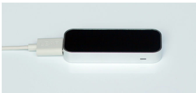
Obrázek 2.4: Snímač Leap Motion Controller [12]
