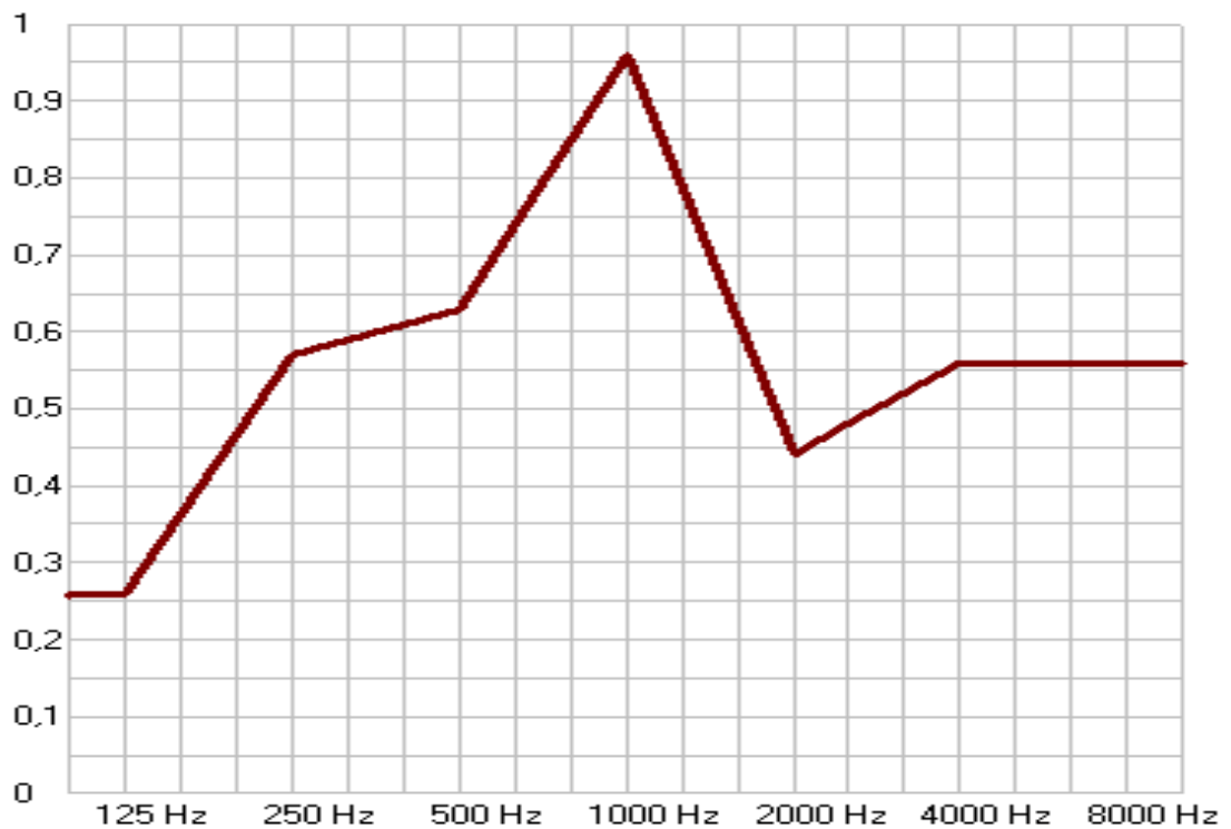
Obrázek 7.4: Absorpční koeficient materiálu Acoustile v závislosti na frekvenci
