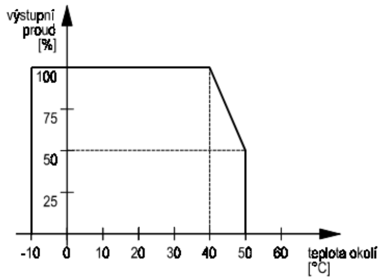
Obrázek 2.1.2 Graf korekce elektrického proudu v závislosti na teplotě
