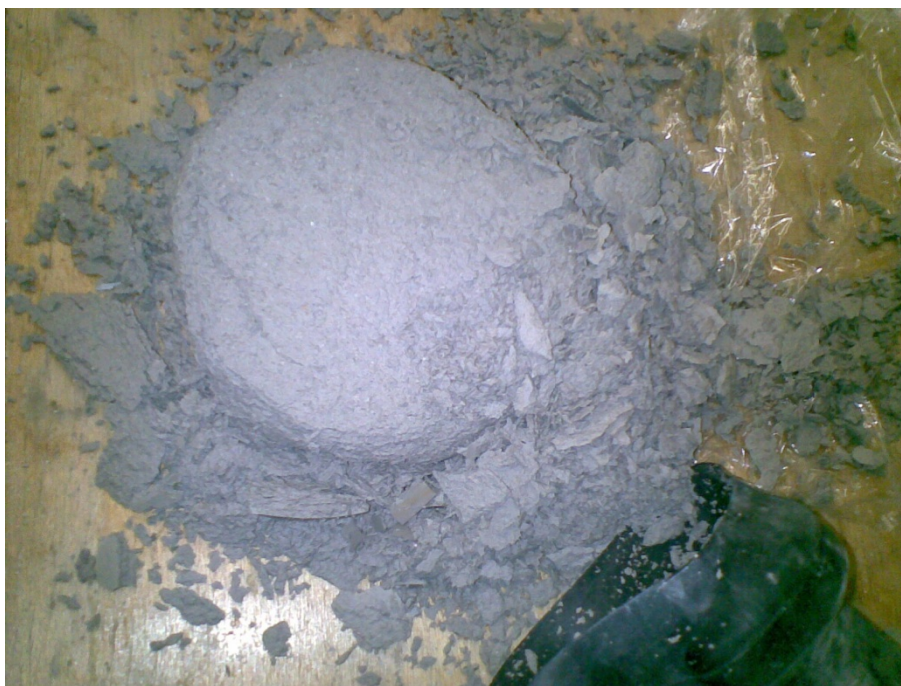
Obr. 66: Rozpadlý vzorek směsi s přidáním Dastit UX po 50 cyklech zmrazování
