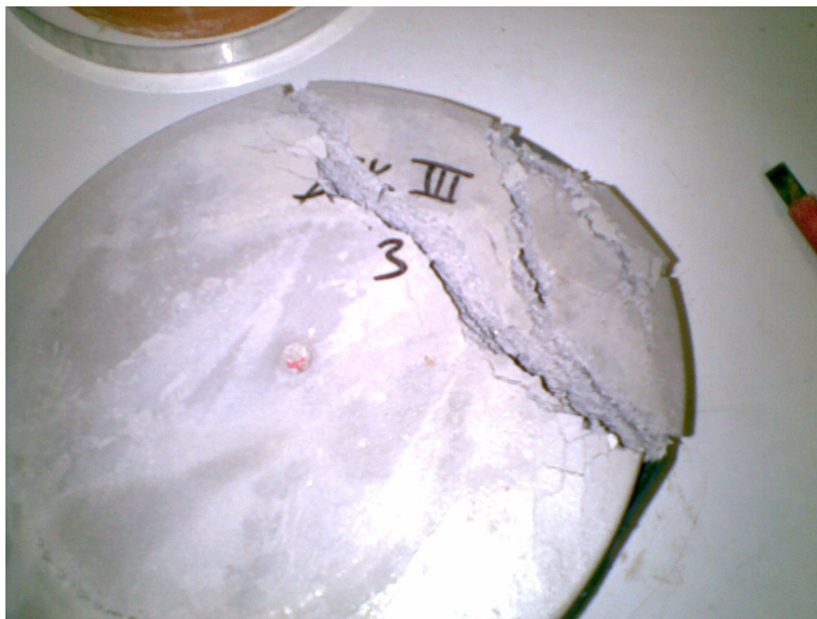
Obr. 67: Rozpadlý vzorek směsi s přidáním popílku Tisová po 50 cyklech zmrazování
