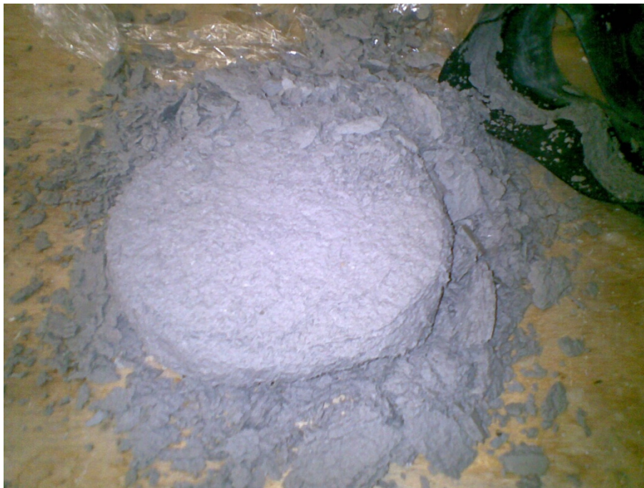
Obr. 65: Rozpadlý vzorek směsi s popílky Tisová
