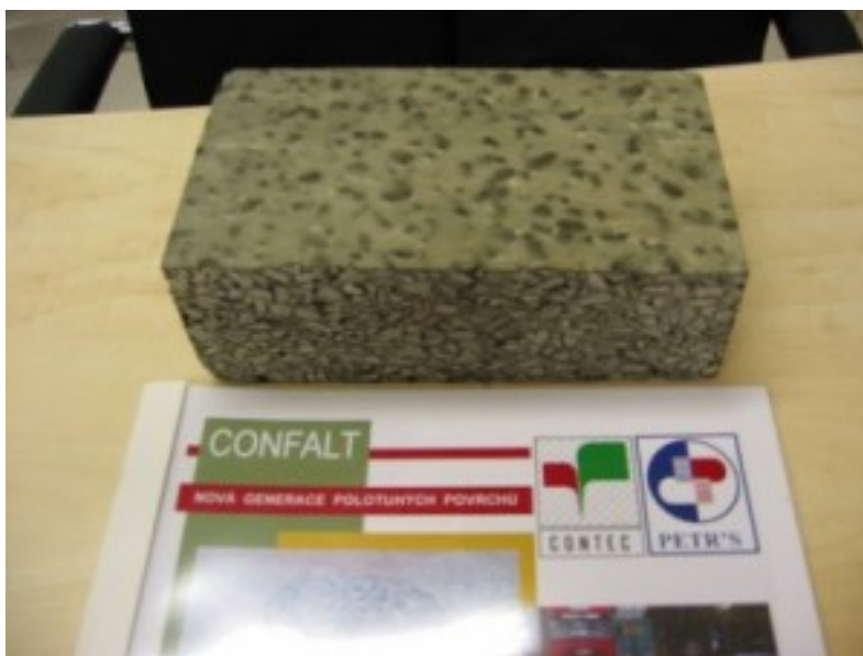
Obr. 6: Výřez hotového povrchu – Confalt
