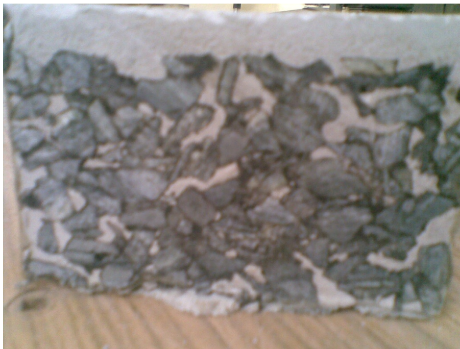
Obr. 78: Řez asfaltocementovým betonem směsí s popílkem z Tisové
