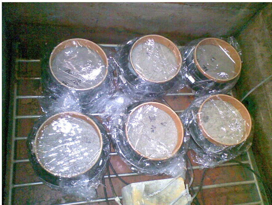
Obr. 37: Zabalené vzorky v mrazicí komoře před prvními 25 cykly
