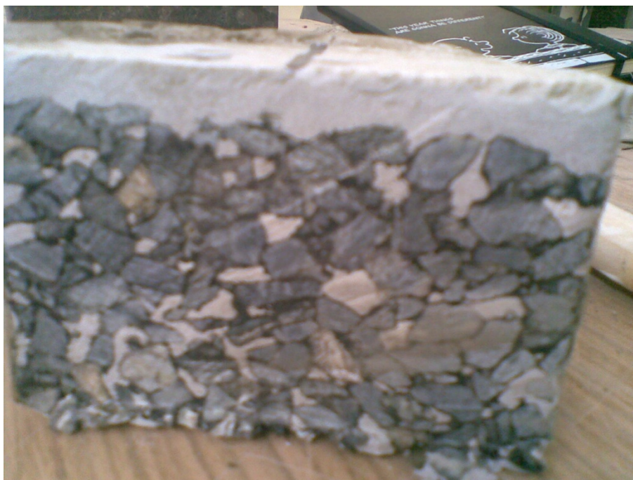
Obr. 76: Řez asfaltocementovým betonem referenční směsi
