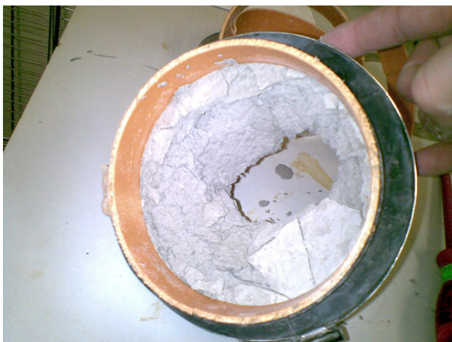
Obr. 68: Rozpadlý vzorek směsi s přidáním popílku Tisová po 50 cyklech zmrazování
