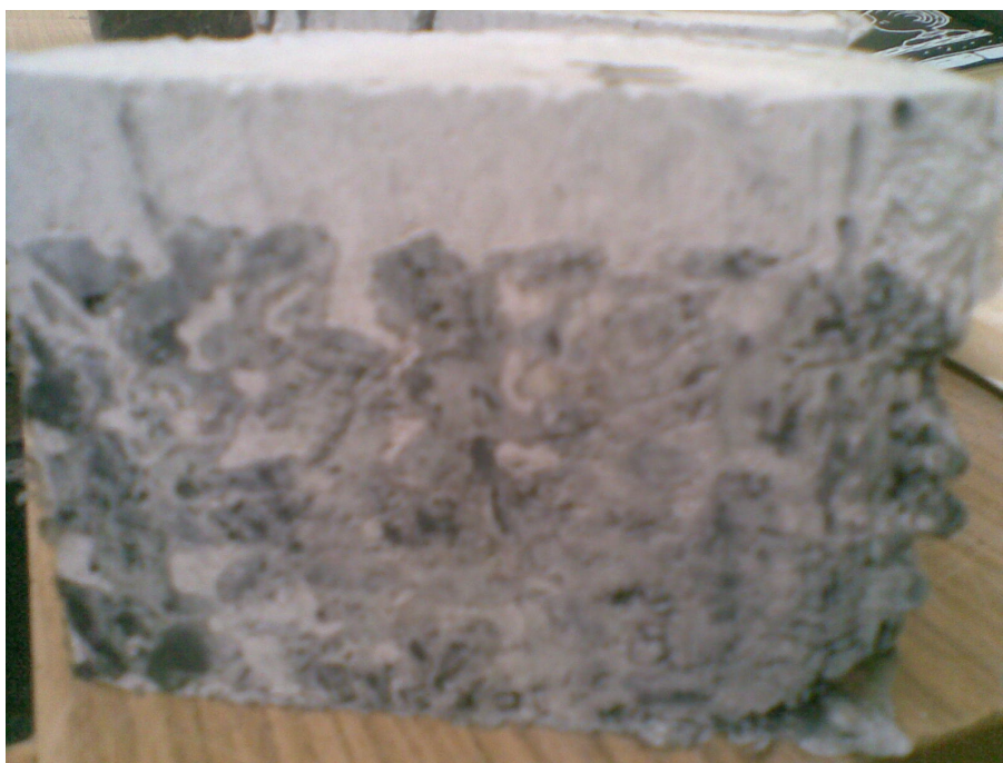
Obr. 77: Řez asfaltocementovým betonem směsi s Dastitem UX
