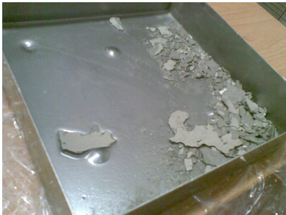
Obr. 39: Povrchová krusta, která odpadla po prvních 25 cyklech
