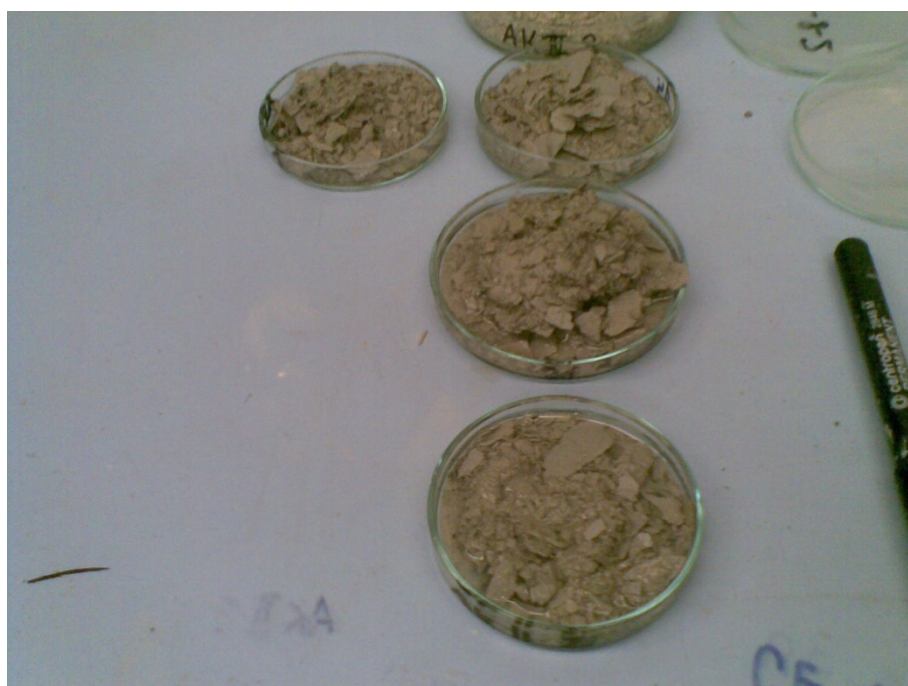
Obr. 40: Vysušený zbytek z prvních 25 cyklů
