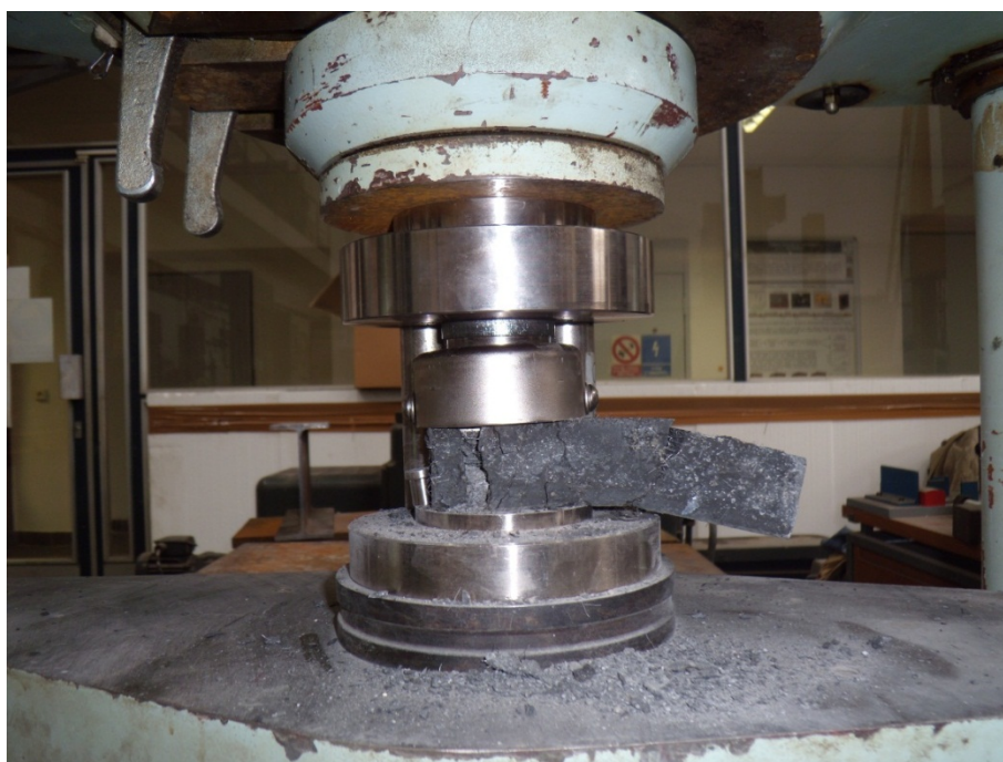
Obr. 32: Zkouška pevnosti v tlaku na zbytcích trámečků
