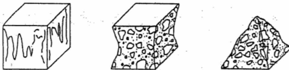
Obr. 33: Vyhovující způsoby porušení zkušebních krychlí [53]
