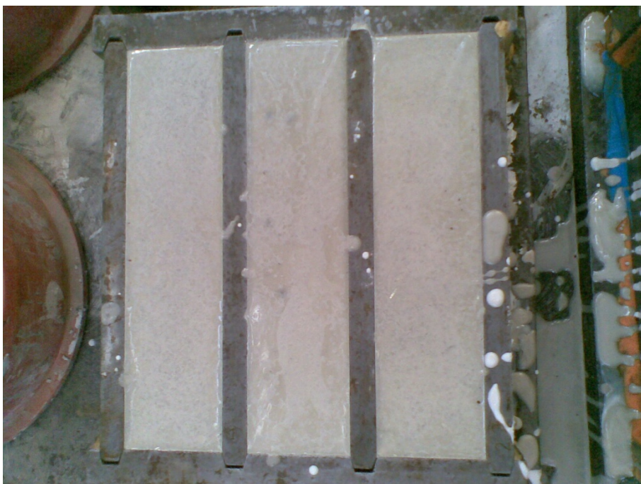
Obr. 26: Vylitá forma cementovou maltou
