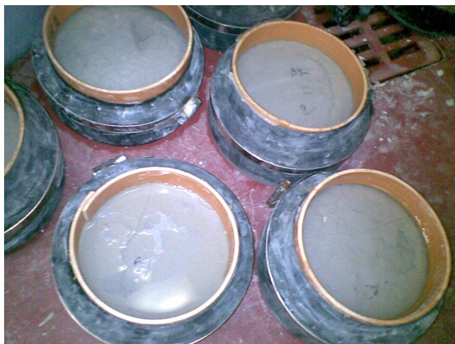
Obr. 38: Připravené vzorky k mrazicímu zařízení na druhých 25 cyklů
