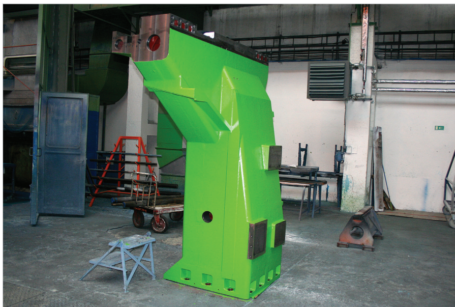
Realizovaný stojan stroje FRF firmy TOS Kuřim-OS s optimalizovanou vnitřní strukturou
