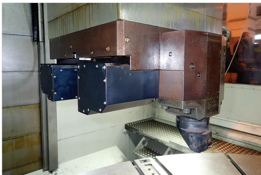
Soustružnický adaptér s integrovaným hltičem na karuselu Toshulin
