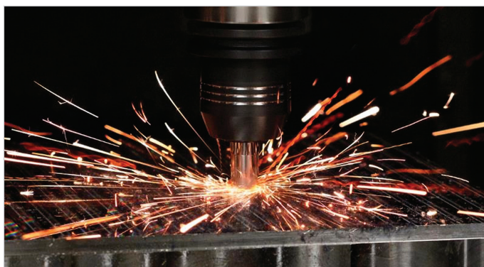
Test frézování kalené oceli (58 HRC) s dosažením vysoké jakosti povrchu
