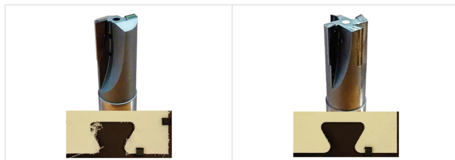
Kvalita obrobenej hrany dílce z materiálu G/PA12 – technologie s využitím původního nástroje (vlevo), technologie s využitím nové vyvinuté nástroje (vpravo)
