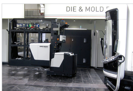
Autonomně se pohybující platforma pro zajištění manipulace s vyráběnými dílci (DMG Mori)
