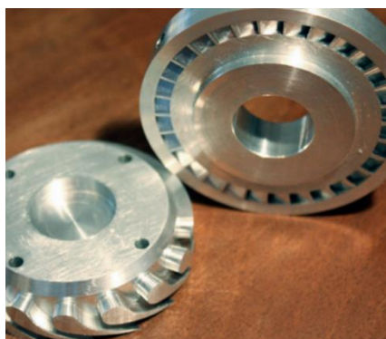
Obr. 2-5 Rozváděcí a oběžné kolo axiální turbíny Enogia [20]
