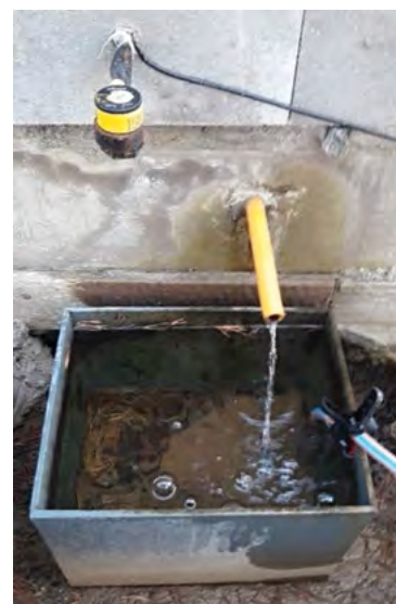
Obr. 4. Jímka pro sběr průsakové vody vybavená ultrazvukovým senzorem pro sledování hladiny vody a vypouštěcí hadicí se sacím košem
