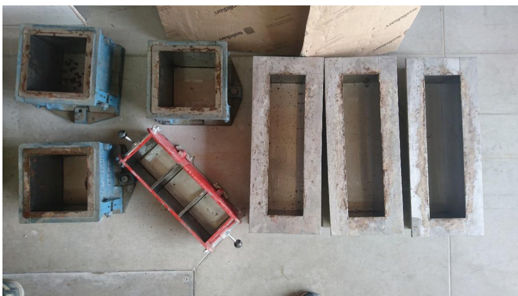
Obrázek 6.2 - Ocelové formy pro kontrolní vzorky
