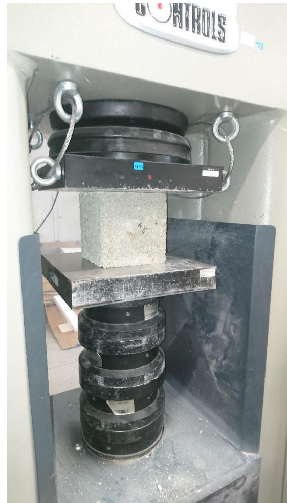
Obrázek 6.13 - Zjišťování krychelné pevnosti v tlaku
