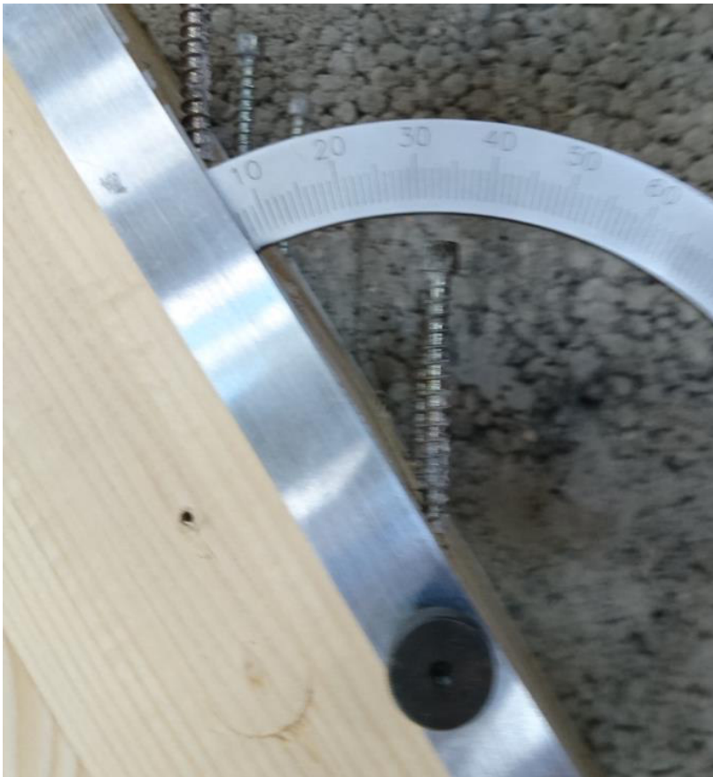
Obrázek 6.15 - Změna sklonu spřahovacího vrutu po zkoušce
