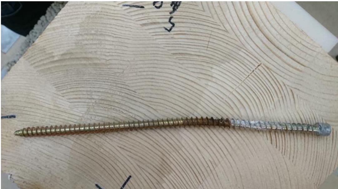
Obrázek 6.16 - Spřahovací vrut po zkoušce
