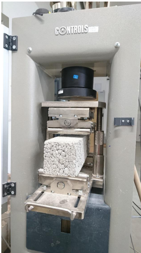
Obrázek 6.12 - Zjišťování pevnosti vtahu za ohybu
