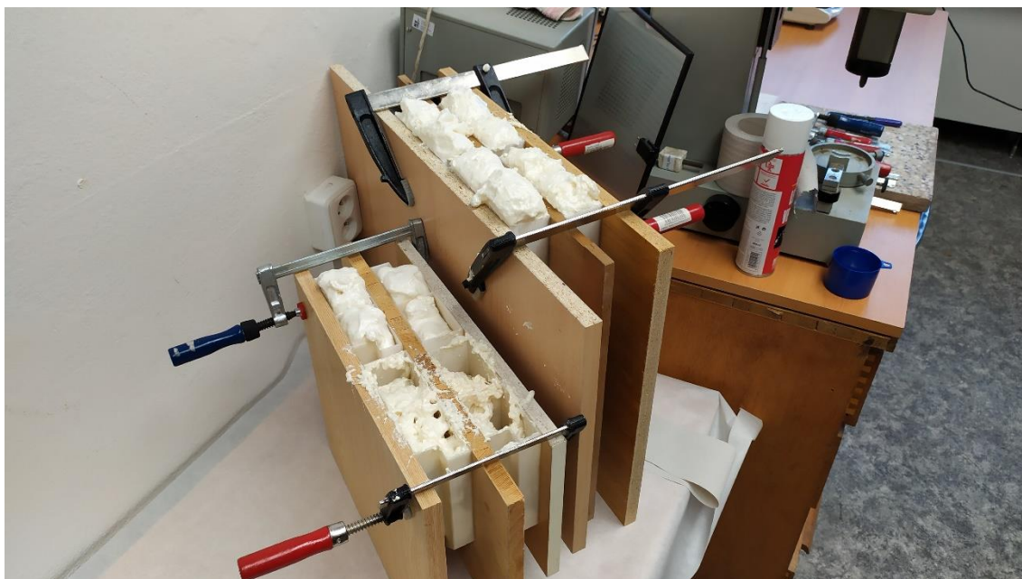
Obrázek 84 Panely vyplněné PUR pěnou [autor]
