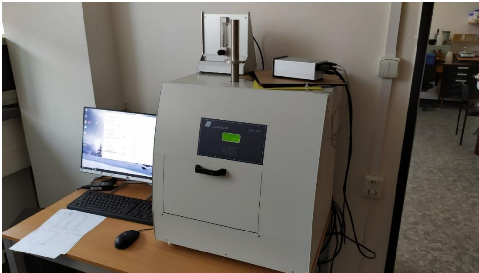
Obrázek 88 Měřič tepelného toku Linseis HFM 300 [autor]
