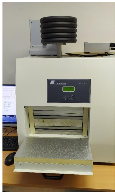
Obrázek 90 Naplněný panel C v měřícím přístroji zatížený závažími [autor]
