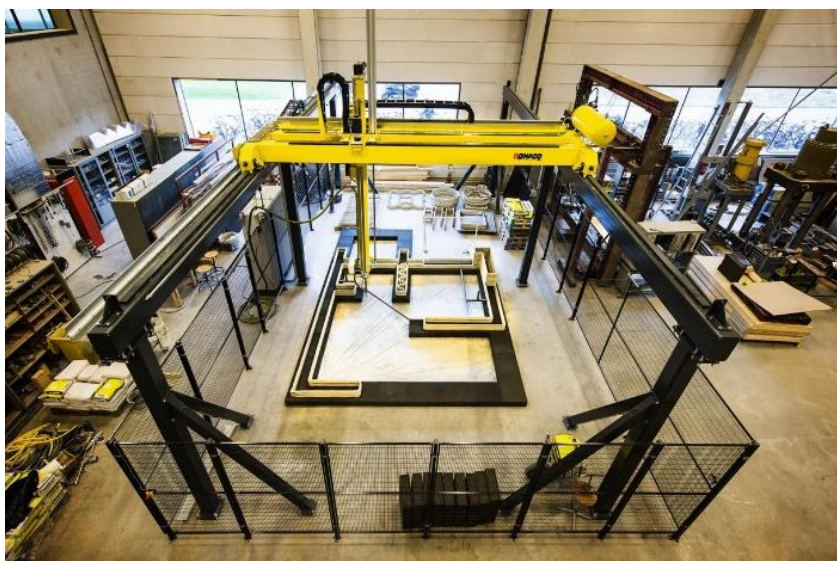
Obrázek 16 Rámová velkoformátová 3D tiskárna [28]
