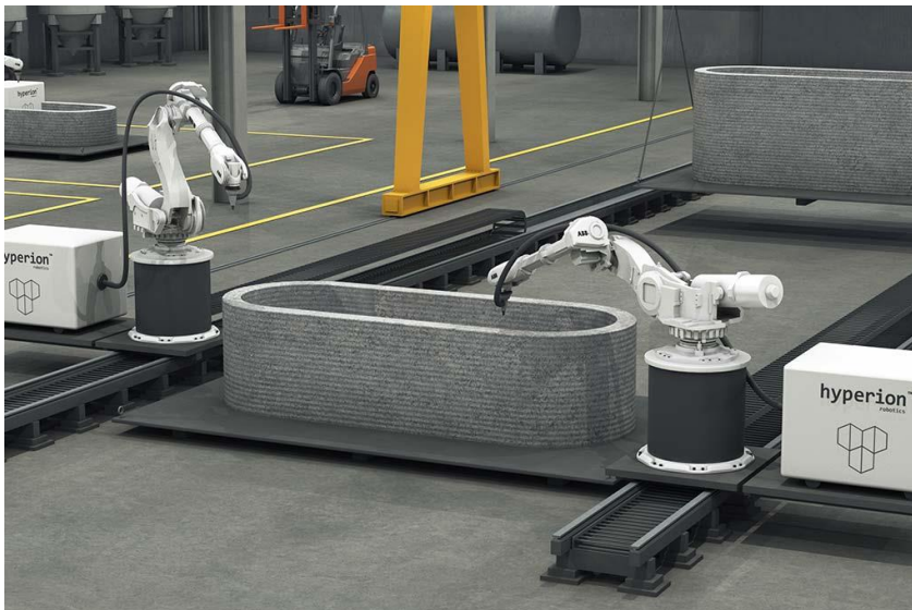
Obrázek 17 Robotická technologie pro 3D tisk z betonu [Hyperion Robotics]
