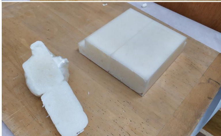
Obrázek 86 Odříznutá přebytečná PUR pěna [autor]
