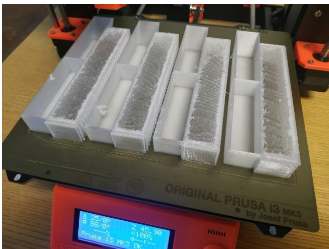
Obrázek 78 Nezdařený tisk panelu D [Ing. M. Kovářik]
