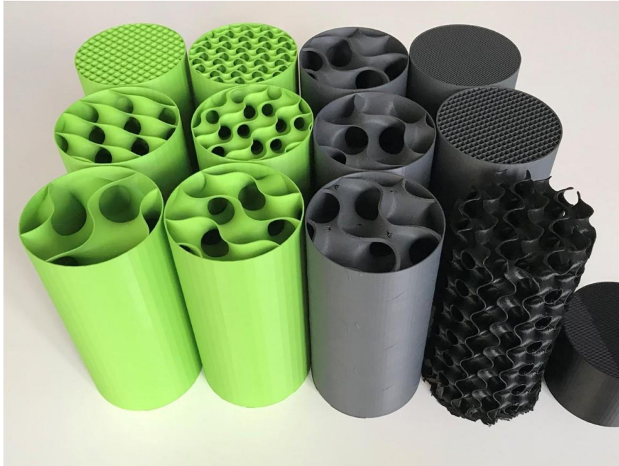
Obrázek 25 Sloupy s vnitřní výplní na principu minimálních ploch, vytištěné z plastu [32]
