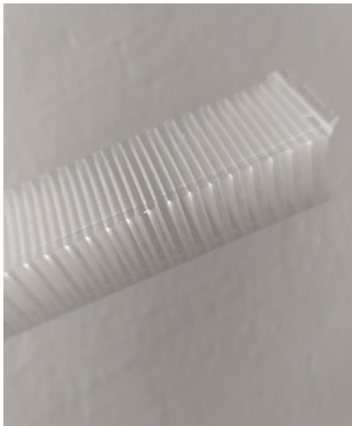
Obrázek 80 Odstraněná tisková podpora [autor]
