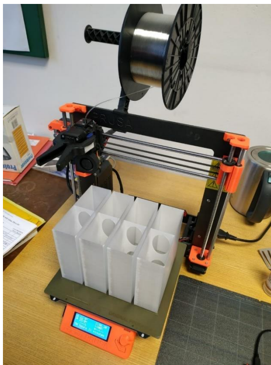
Obrázek 77 Tisk panelů na 3D tiskárně [autor]
