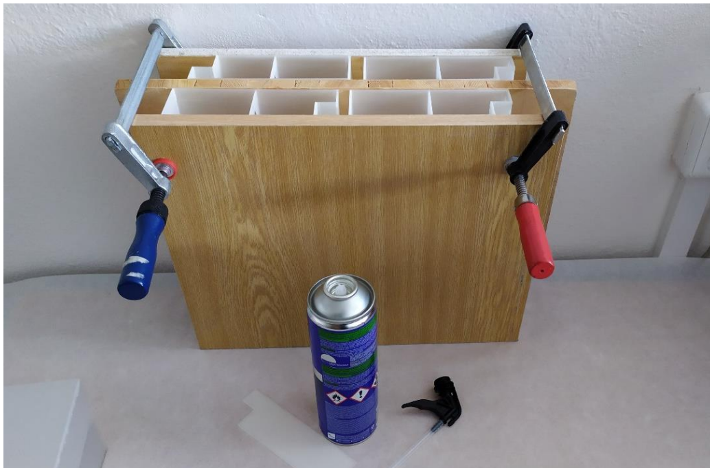
Obrázek 83 Zajištění panelů D proti deformaci během plnění [autor]
