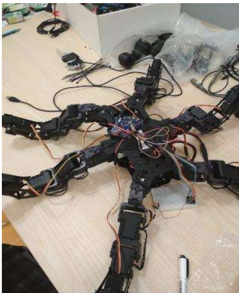
Obrázek 623 - Zapojení elektrických obvodů
