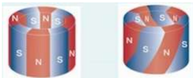
Obrázek 39 - Multipolární radiální magnetizace (26)
