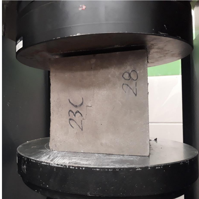
Obrázek 38 - Způsob porušení zkušebního tělesa 23C
