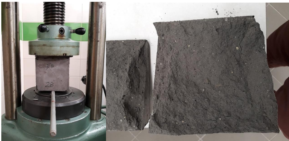
Obrázek 42 - Přelomení a kontrola segregace kameniva u zkušebního tělesa 3B
