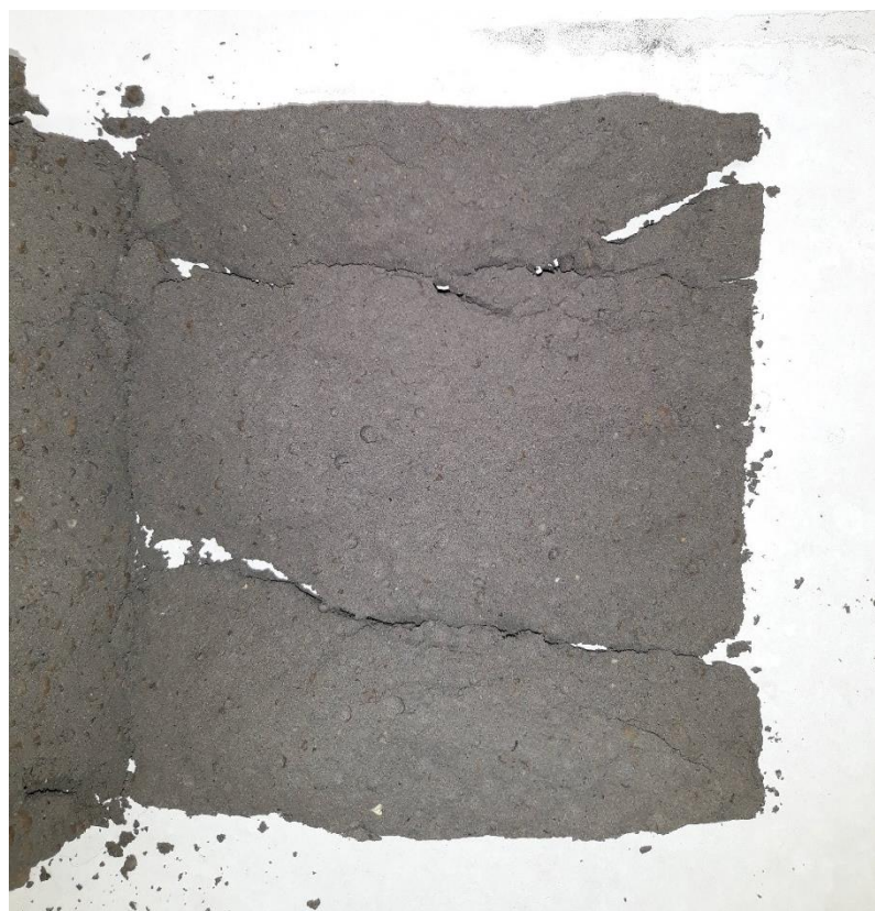
Obrázek 45 - Nevyhovující ověření segregace
