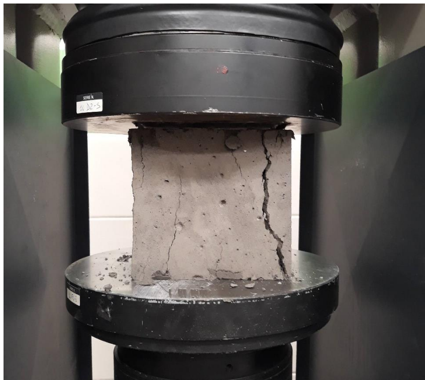
Obrázek 44 - Nevyhovující porušení zkušebního tělesa 12B
