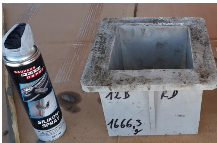
Obrázek 17 - Zkušební forma (krychle 150x150x150 mm)
