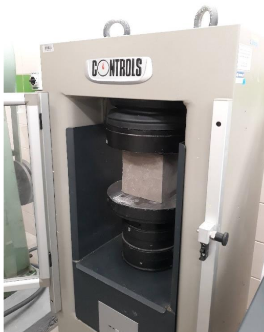
Obrázek 34 - Použitý zkušební lis CONTROLS 50-C78Z00
