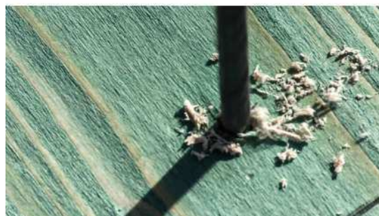
ČTYŘBŘITÝ VIDIOVÝ VRTÁK PROJDE SNADNO DŘEVEM
