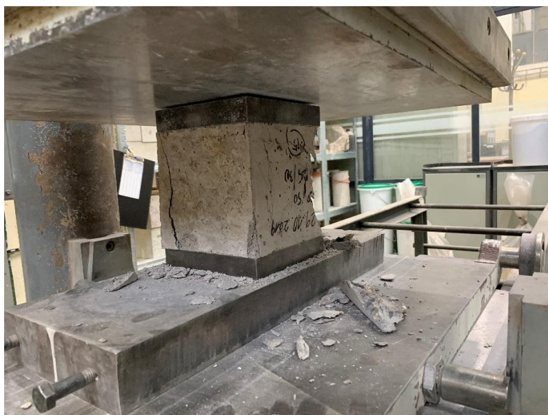
Obrázek 29 - Zkouška pevnosti v tlaku ve zkušební lisu
