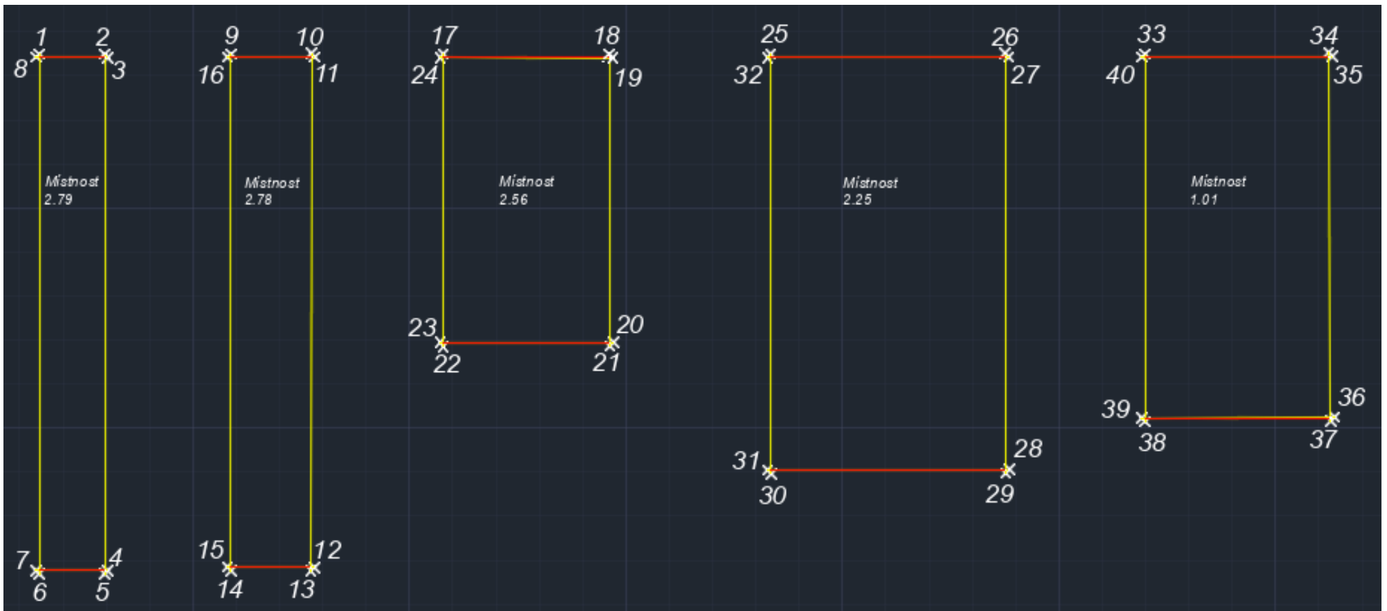
Obrázek 26 - Geodeticky zaměřené body pro stanovení úhlových odchylek
