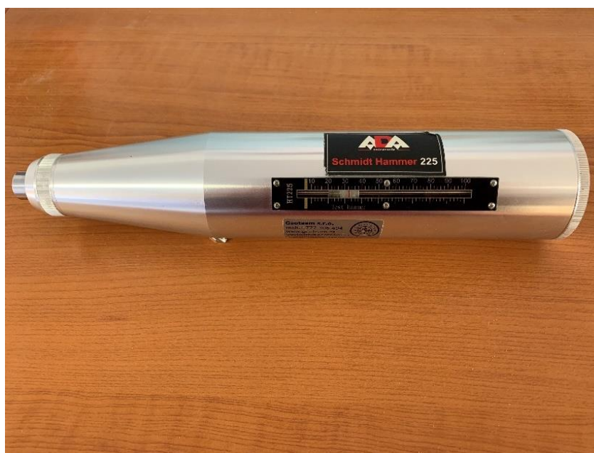
Obrázek 30 - Přístroj pro zkoušku pevnosti betonu v tlaku (odrazový tvrdoměr)
