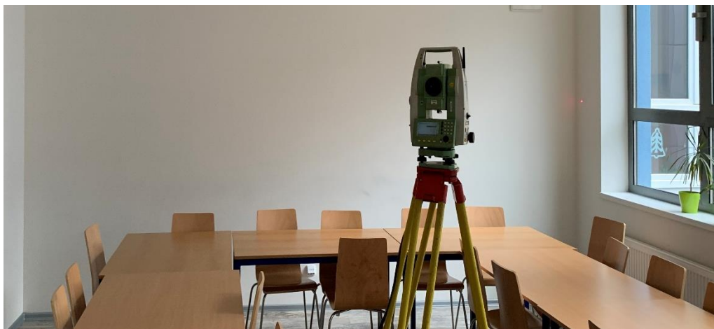
Obrázek 24 - Měření totální stanicí Leica TS06 plus
