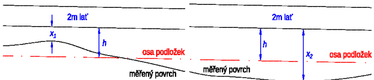
Obrázek 11 - Vyhodnocení mezních odchylek při měření latí s podložkami
