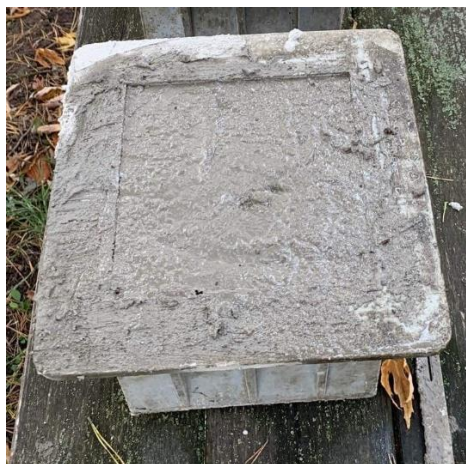
Obrázek 27 - Betonový vzorek pro krychelnou zkoušku pevnosti v tlaku
