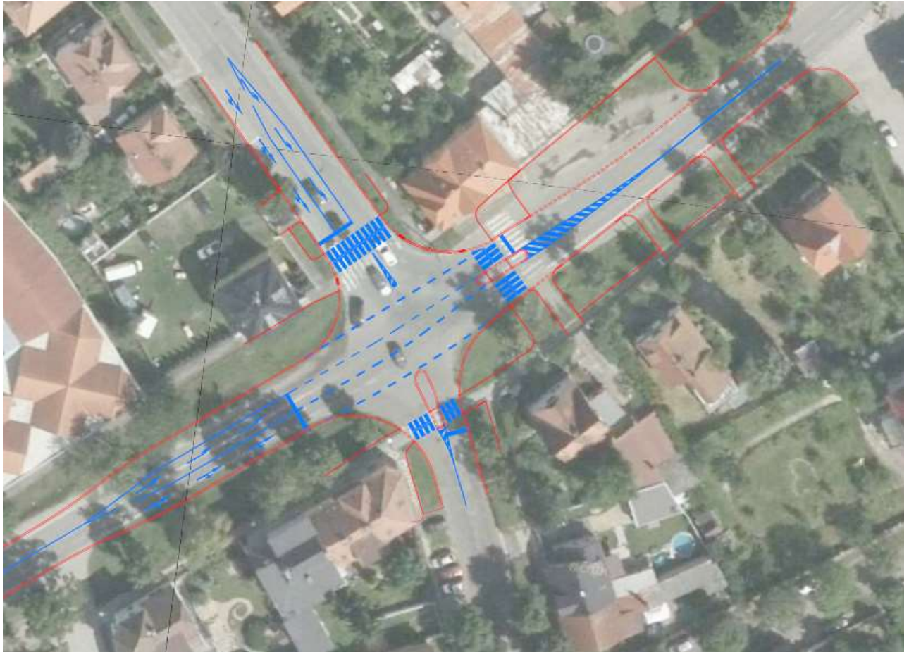
Obrázek 4: Uspořádání křižovatky řízené SSZ (Varianta C)
