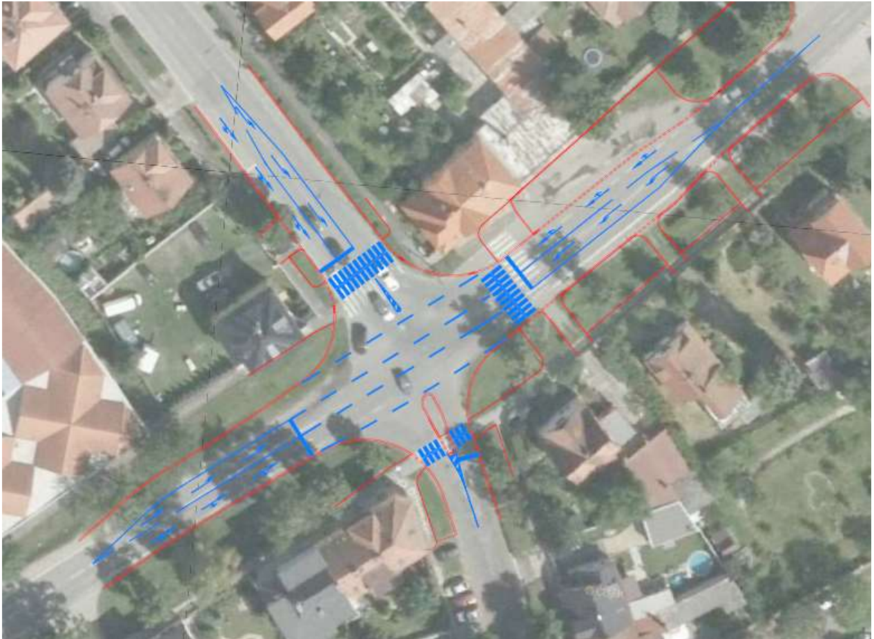
Obrázek 1: Uspořádání křižovatky řízené SSZ (varianta B)
