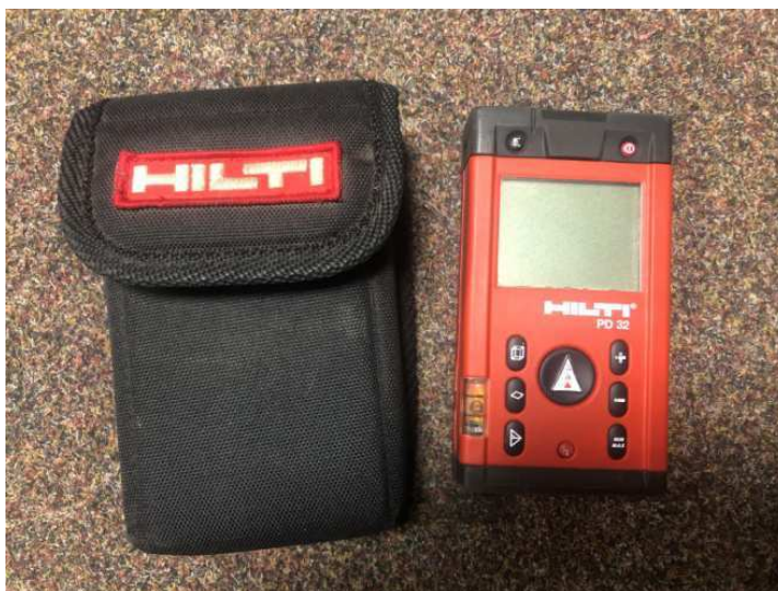
Obr. 33 – Laserový dálkoměr Hilti PD 32
