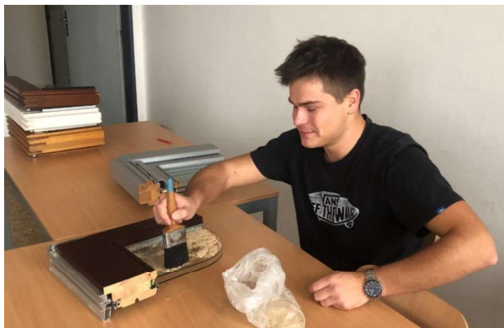
Obr. 129: Znečištění interiérové strany okna prachem z dřevěných pilin
