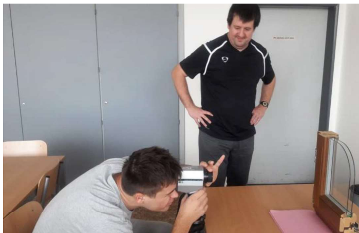
Obr. 128: Měření jasu skrze okenní výplň (dvojsklo)
