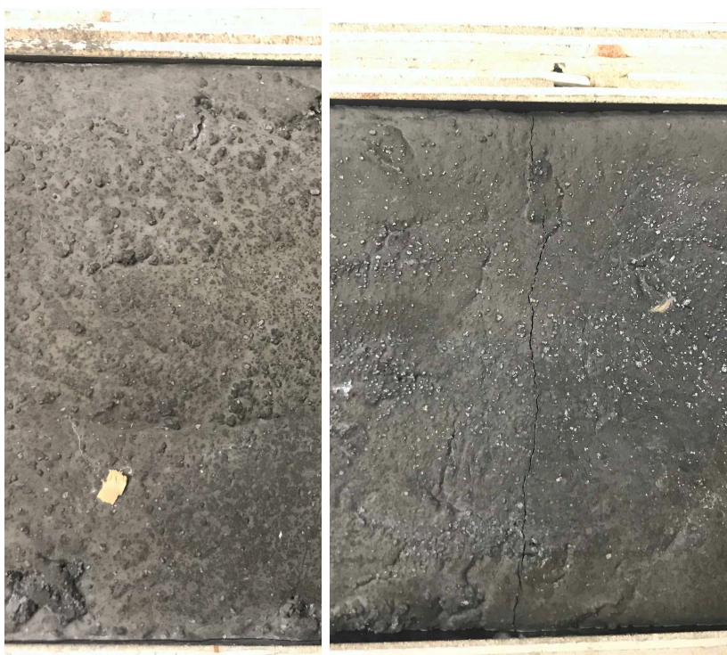
Porovnání vzniku a eliminace trhlin u předepnutého (vlevo) a nepředepnutého (vpravo) prvku.
