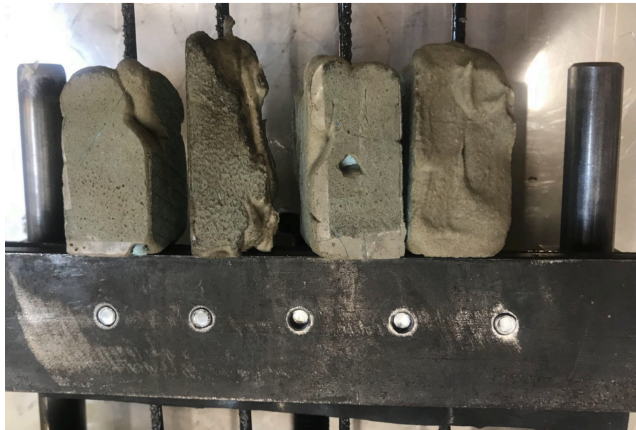
Zakotvení rovingů za pomoci chemické malty jako zarážky.
