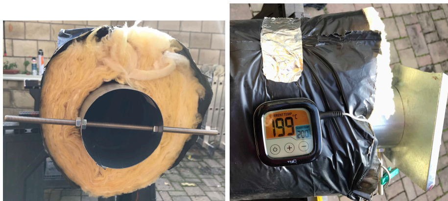
Reálný pohled na řez vytvrzovací pece (vlevo). Pohled na teploměr s hodnotou teploty na konci pece.
