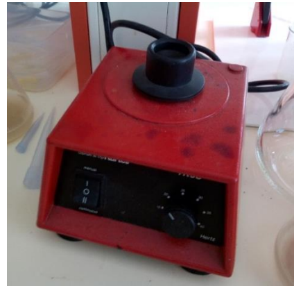
Obrázek 50: Stolní míchadlo techno Kartell TK3S (Foto autor)
