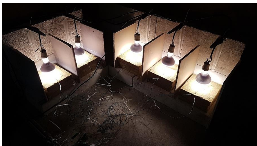
obr. 28: Degradace skupiny vzorků C UV žárovkou – začátek (3. 9. 2019)
