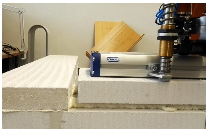
Obr. 77: Zkouška 2 – uložení další řady tvárnic [autor]
