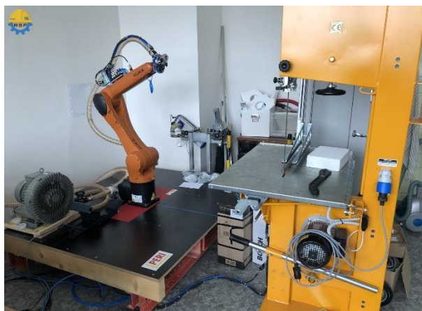
Obr. 30: Robotické zdící pracoviště [40]
