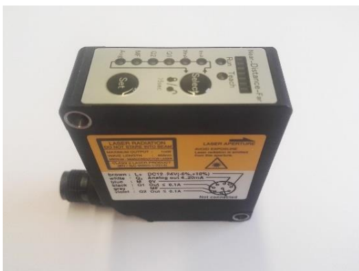
Obr. 37: Laserový senzor pro měření vzdálenosti [autor]
