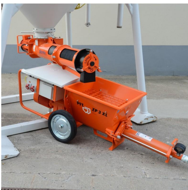
Obr. 46: Sestava míchacího zařízení PFT LOTUS a dopravního zařízení PFT SWING [42]
