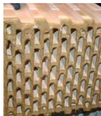
Obr. 10: Namočená spodní ložná část tvárnice [2]
