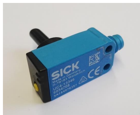
Obr. 36: Ultrazvukový senzor pro měření rovinnosti [autor]
