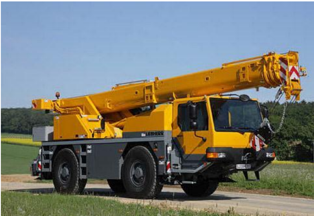
10 Obr. č.10 Mobilní jeřáb Liebherr LTM 1030-2.1.
