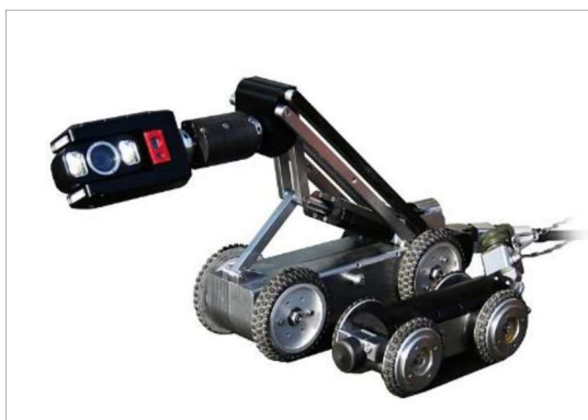
Obr. 42: Příklad kamery pro kamerový průzkum potrubí.
