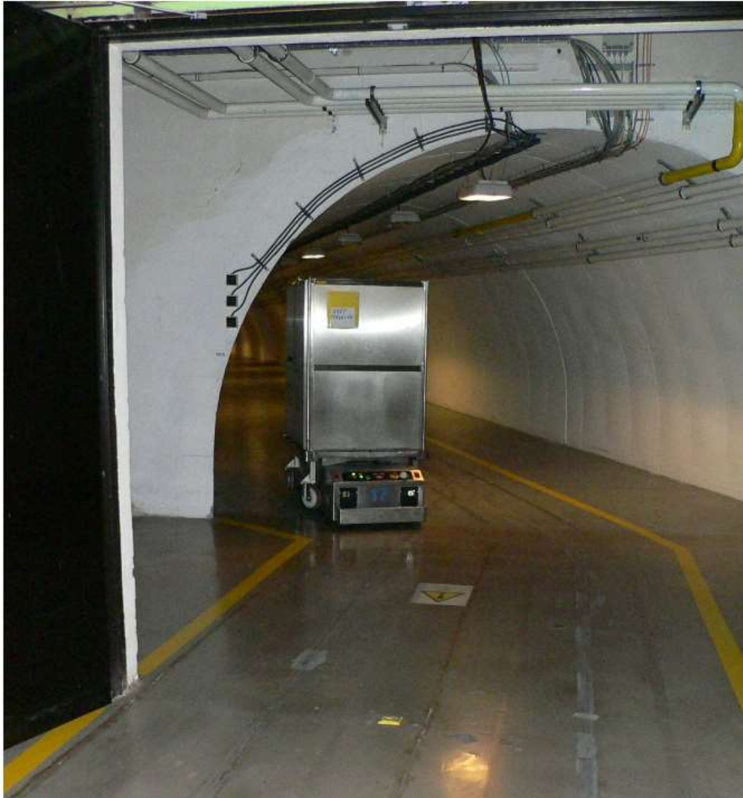
Obrázek č. 16: Fotografie robotického samostatně se pohybujícího vozíku ve vymezené kolejové dráze (žlutě vyznačené pásy na podlaze)
