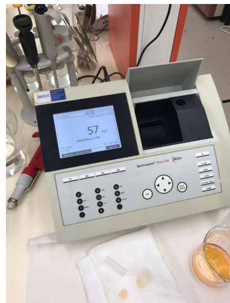
Obrázek 26 – Fotometr na analýzu zasolení zdiva
