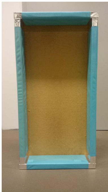
Obr. 40 KVH rám s izolací Steico Protect dry – pohled 1
