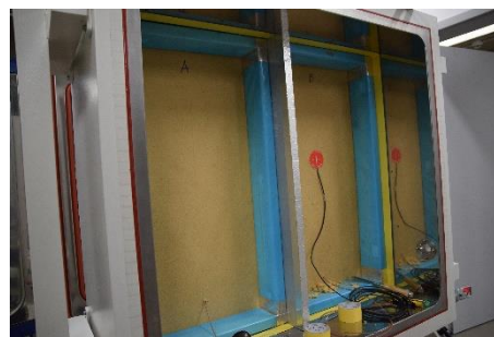
Obr. 45 KVH rámy vloženy do zkušebního rámu
