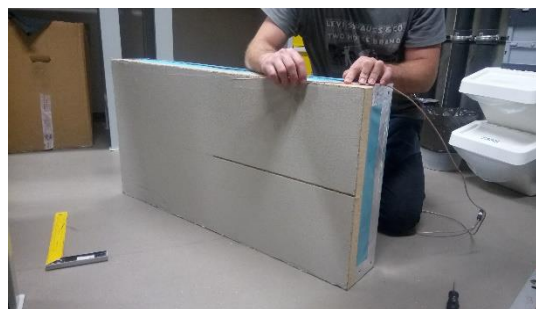
Obr. 43 KVH rám s drážkou pro čidlo
