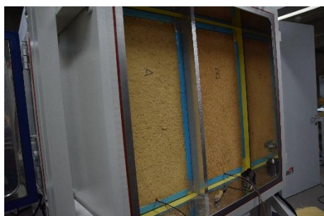
Obr. 48 KVH rámy s izolací Steico flex
