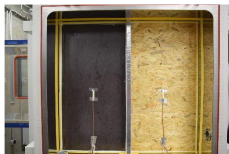
Obr. 49 KVH rámy zaklopeny OSB deskami
