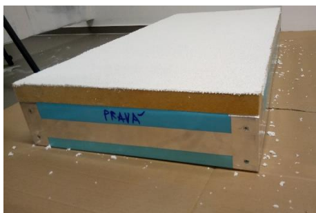
Obr. 44 KVH rám s fasádní omítkou
