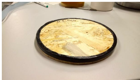
Obr. 27 Vzorek obalený butylkaučukovou páskou
