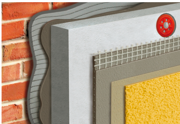
Obr. 11 - Příklad kontaktního zateplovacího systému [13]
