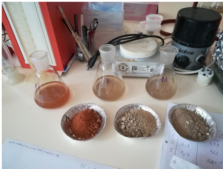
Obr. 59 2 g vzorku zalité 100 ml destilované vody
