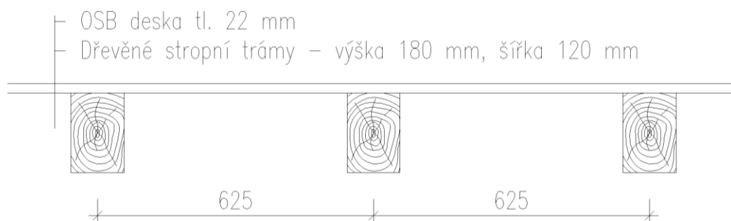
Obrázek 51 - Schéma „strop 1“
