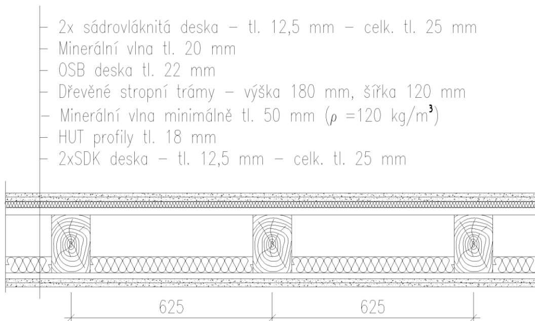
Obrázek 21 - Schéma doporučené skladby
