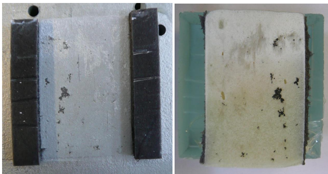
Obr. 5.13: Adhezní porušení spoje od oceli
