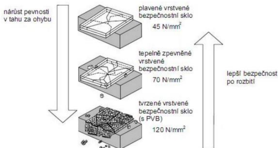
Obr. 2.8: Typy porušení vrstvených skel
