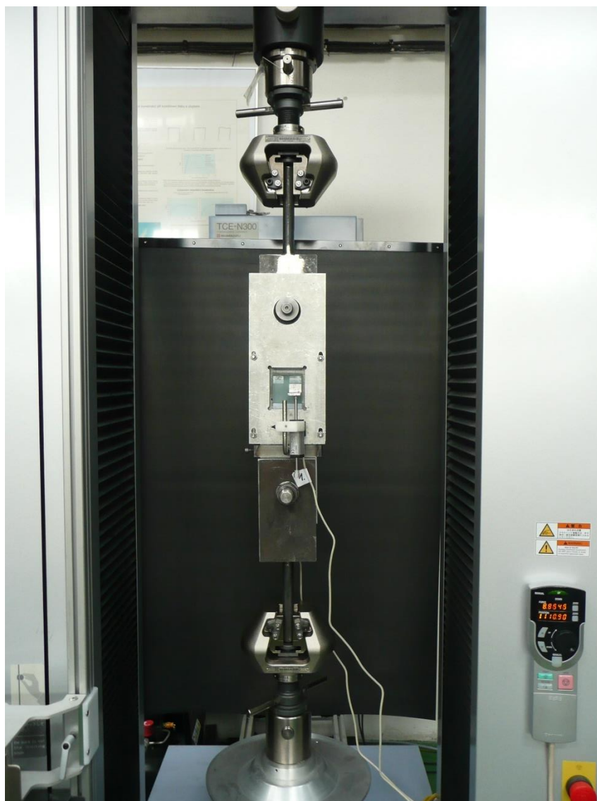
Obr. 5.8: Osazení zkušebního tělesa před začátkem experimentu
