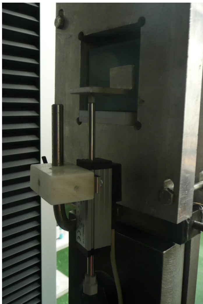
Obr. 5.9: Umístění potenciometru na zkušební těleso
