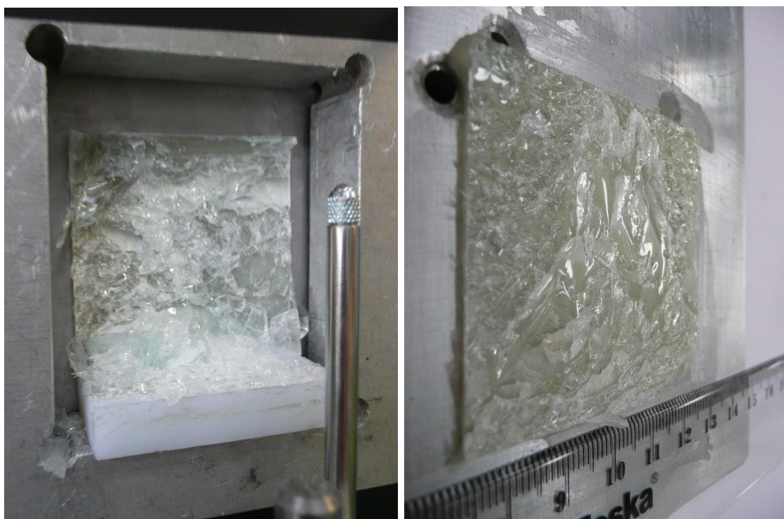
Obr. 5.10: Porušení zkušebních těles, Crestabond M7-05, 1mm
