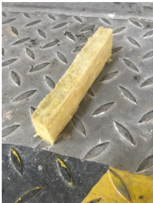
Obrázek 66 – Tepelná izolace ocelového spoje
