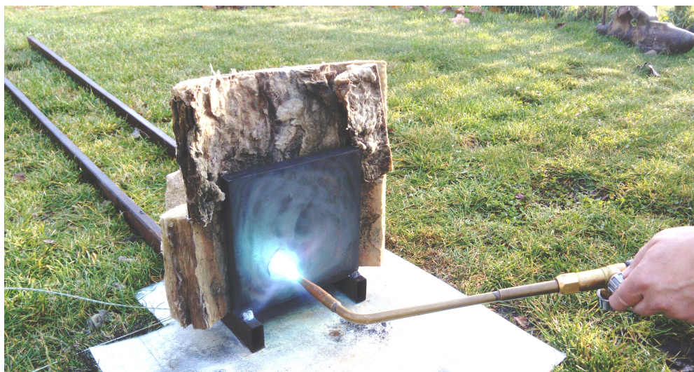
Ohřev vzorku oceli hořákem se směsí kyslíku a acetylenu
