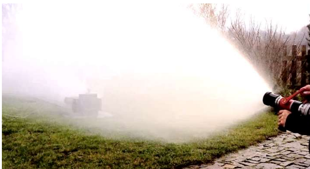
Ochlazování vzorku sprchovým proudem (úhel rozstříku cca 75°)
