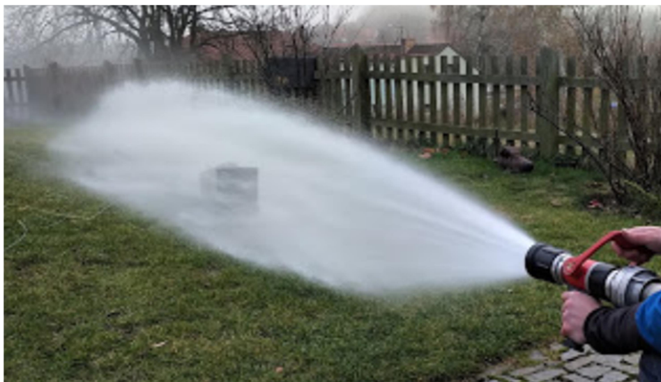
Ochlazování vzorku sprchovým proudem (úhel rozstříku cca 30°)
