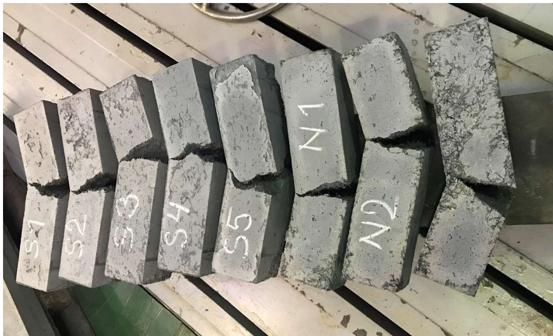
Obr. 42 Rozlomené vzorky 100 mm x 100 mm 400 mm, po zkoušce v tahu čtyřbodovým ohybem
