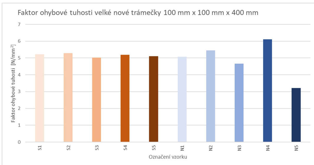
Obr. 49 Graficky znázorněné hodnoty faktoru ohybové tuhosti, oranžové odstíny zorientované vzorky, modré odstíny nezorientované vzorky
