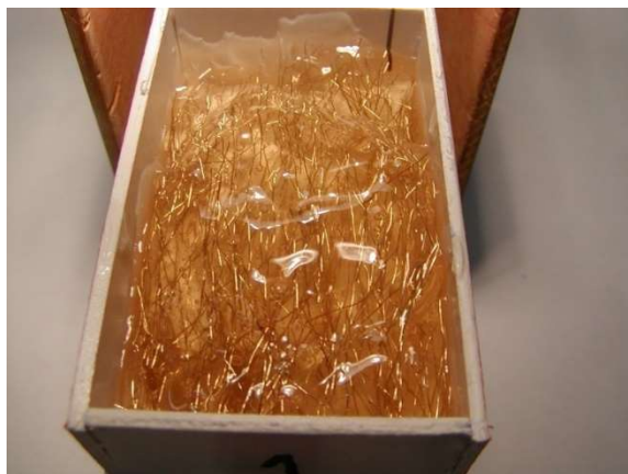
Obr. 22 Vzorek sonogelu s ocelovými vlákny
