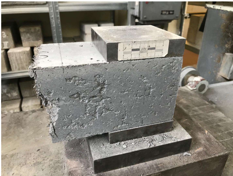
Obr. 44 Příprava vzorku pro zkoušku pevnosti v tlaku, osazení roznášecí ocelové destičky
