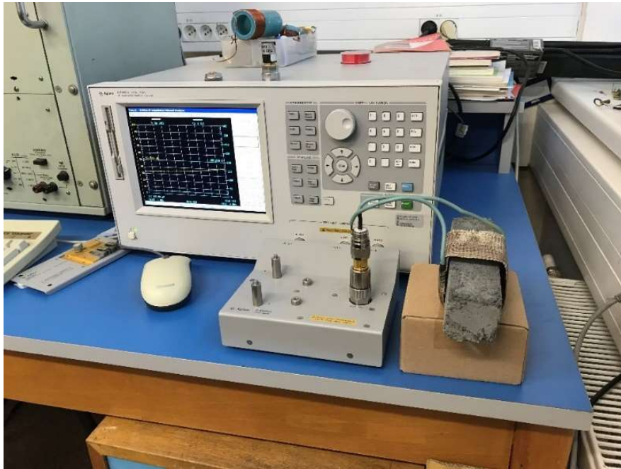
Obr. 36 Měření činitele jakosti cívky Q
