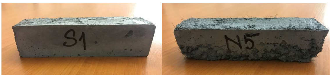
Obr. 33 Odbedněné vzorky 40 mm x 40 mm x 160 mm, rozdílná kvalita povrchu, v levo zorientovaný vzorek, vpravo nezorientovaný vzorek
