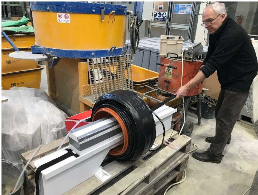
Obr. 35 Zařízení č.2_výroba vzorků z UHPFRC
