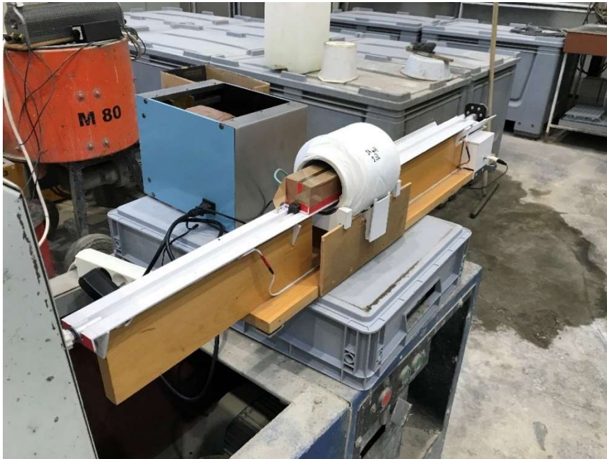
Obr. 34 Zařízení č. 1' _výroba vzorků z UHPFRC
