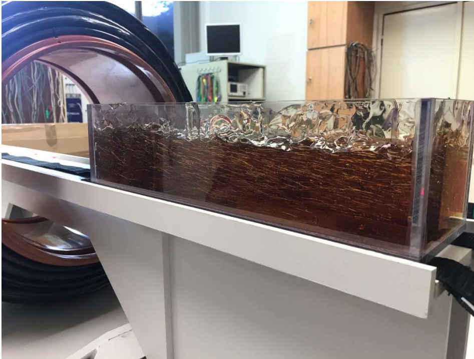
Obr. 31 Testování funkčnosti zařízení č.2 pomocí sonogelu a ocelových vláken v průhledné plastové formě
