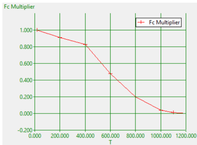
Obr. 28: Snižování pevnosti drátkobetonu v tlaku v závislosti na teplotě
