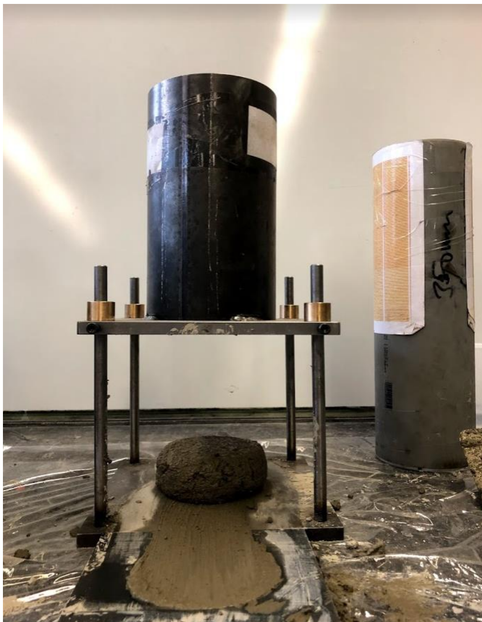
Obrázek 19 - Třetí verze přístroje, uprostřed se nachází přístroj složený ze základní desky, ocelových trnů a vodící ocelové trubky, na pravé straně je zatěžovací nádoba, v přístroji se nachází deformovaný vzorek
