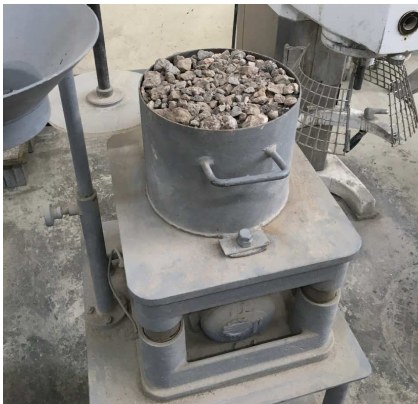
Obrázek 7 Zkouška mezerovitosti setřeseného kameniva (pro frakci 0/64)
