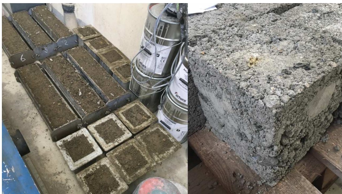
Obrázek 17 Betonový kompozit z recyklovaného kameniva – Etapa 2
