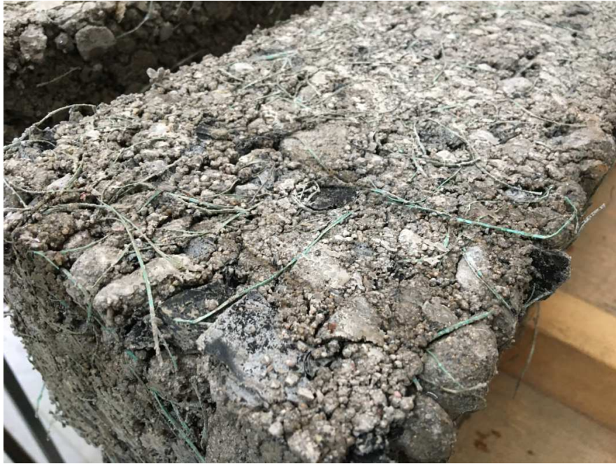
Obrázek 9 Detail vláknobetonového kompozitu s gumovými noky
