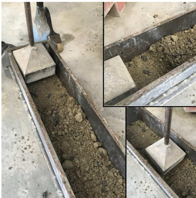
Obrázek 16 Hutnění zkušebního trámce
