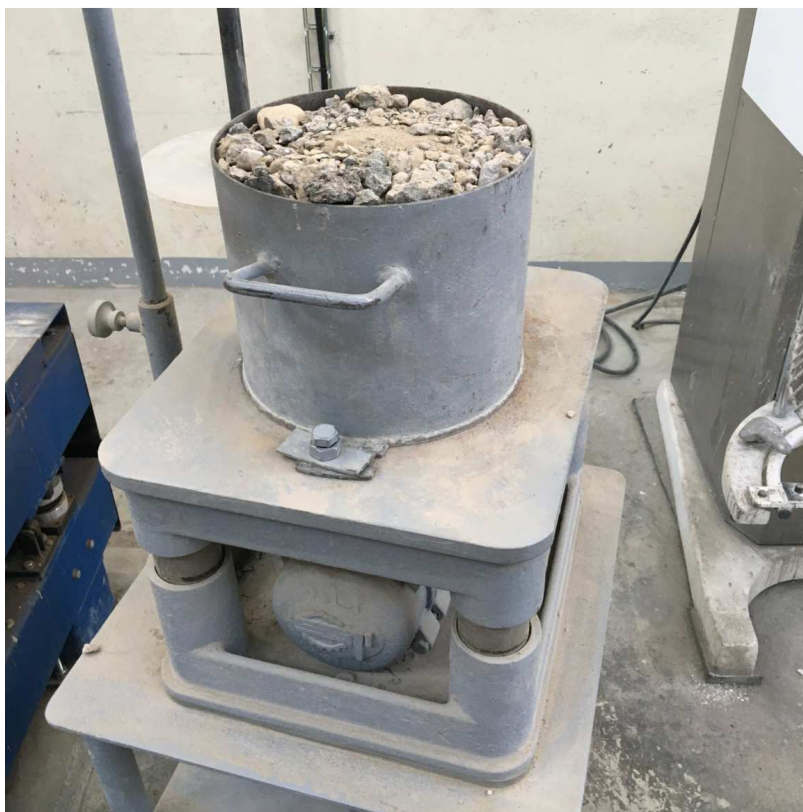
Obrázek 12 Vibrační stůl – zkouška sypné hmotnosti setřeseného kameniva (frakce 0/32mm)
