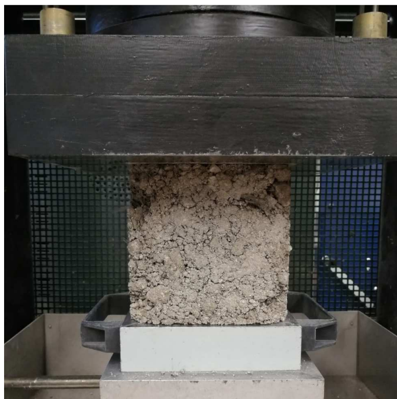
Obrázek 21 Zkouška pevnosti v tlaku na zkušební krychli
