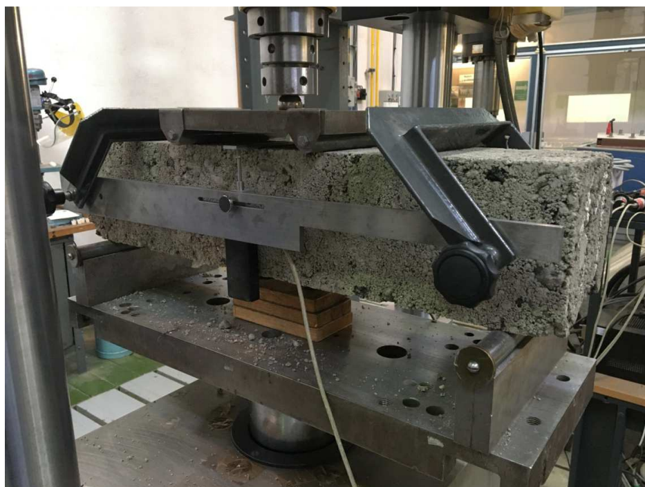
Obrázek 19 Zkouška betonu v ohybu – hydraulický lis
