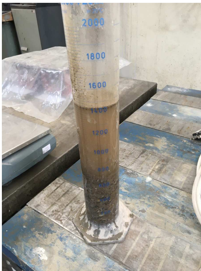
Obrázek 13 Měření objemové hmotnosti recyklátu v odměrném válci
