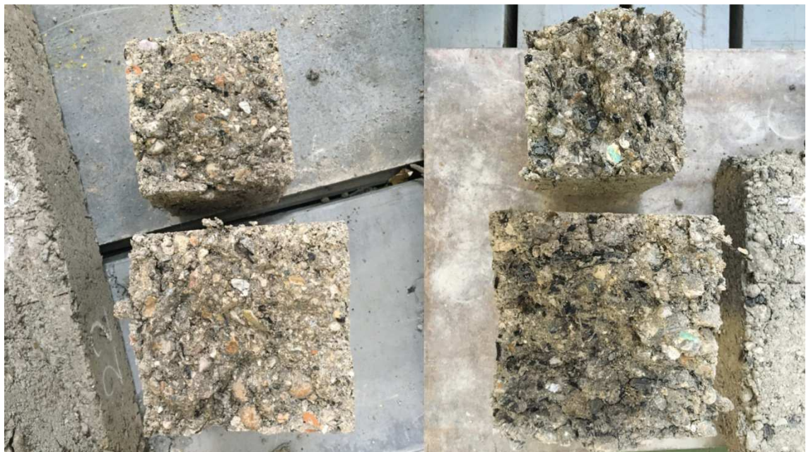
Obrázek 23 Detail lomu zkušebního trámku
