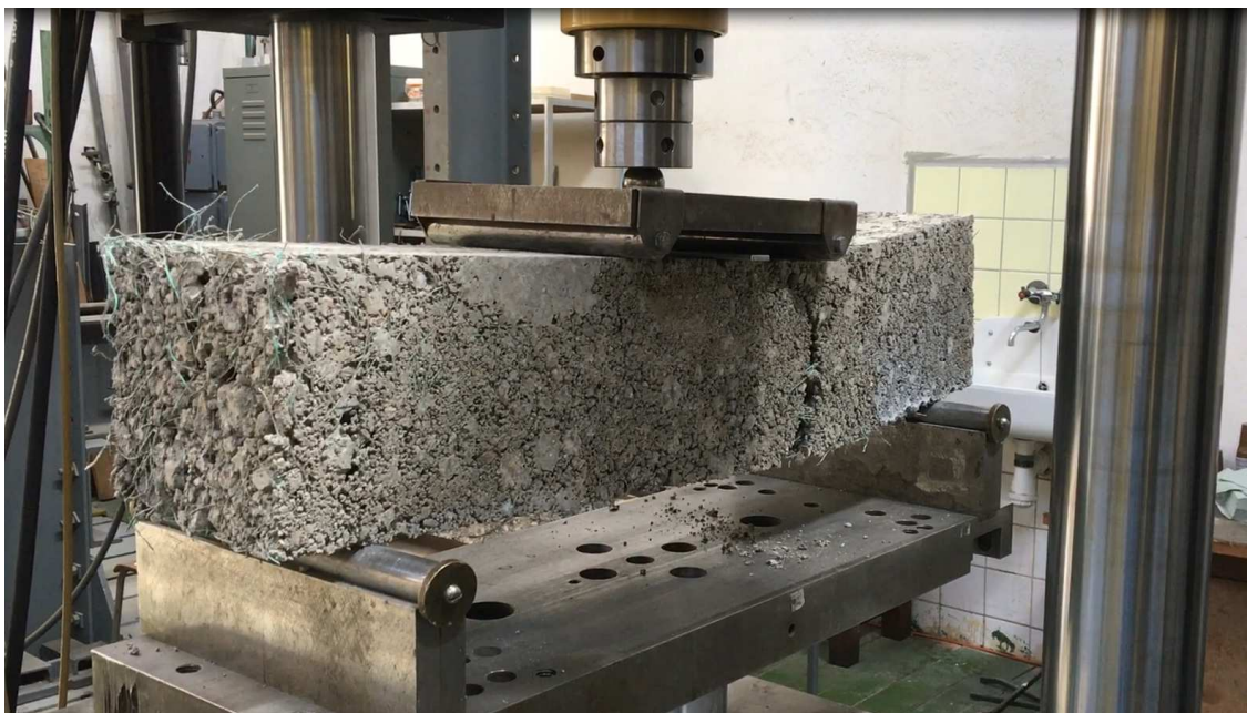
Obrázek 10 Zkouška pevnosti v tahu za ohybu – mezerovitý kompozit
