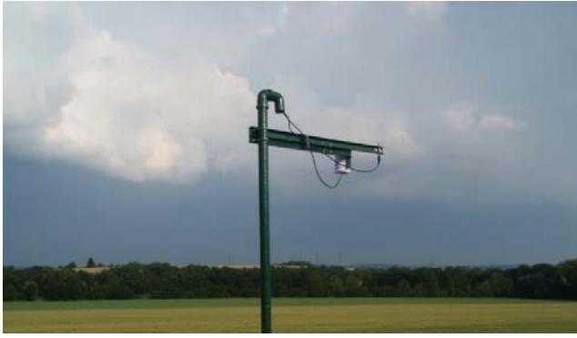
Obr. 5 čidla pro měření oslunění (radiace) a teploty vzduchu (Foto: S. Šulc)
