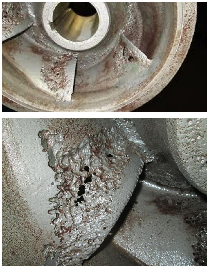
Obr. 32 Ilustrativní obrázek, důsledek kavitace – mechanické poškození oběžného kola, Dostupný z WWW: < https://www.rodelta.com/pump-cavitation/ >
