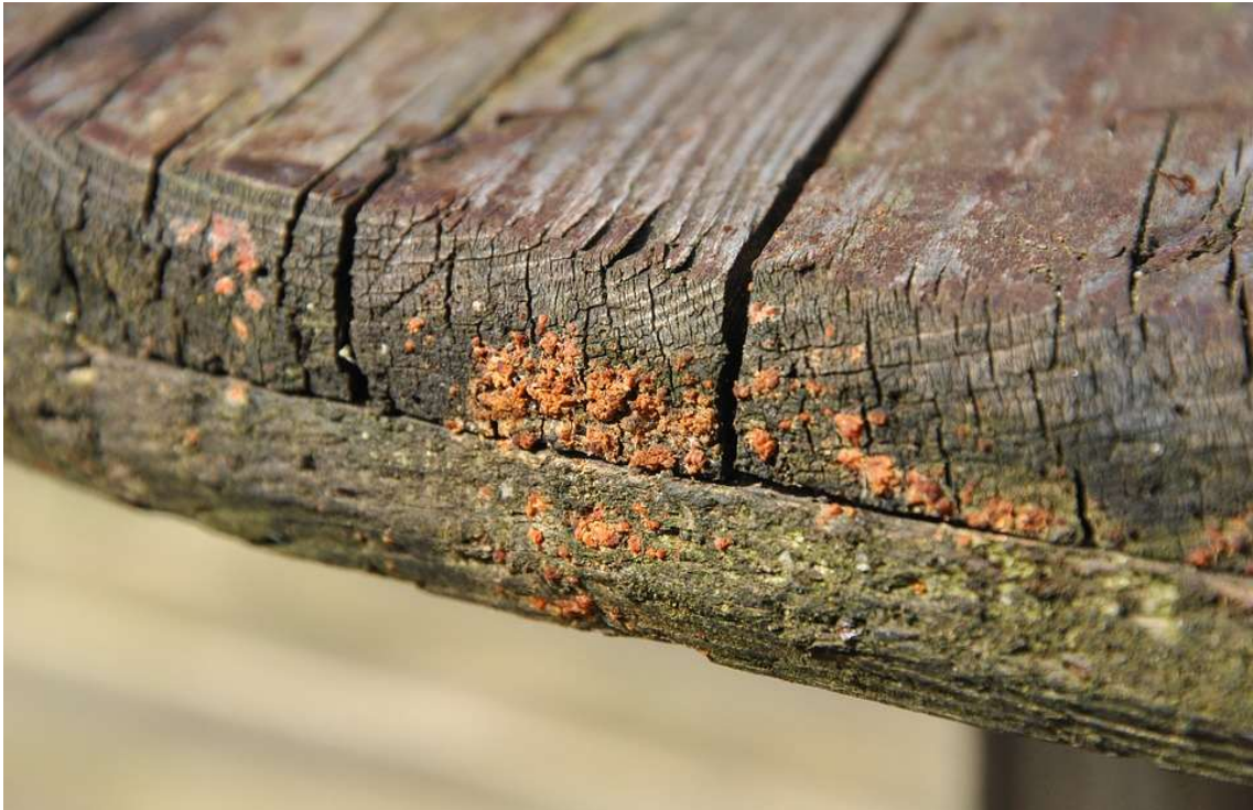
Obrázek 4 - Dřevo napadené dřevokaznou houbou
