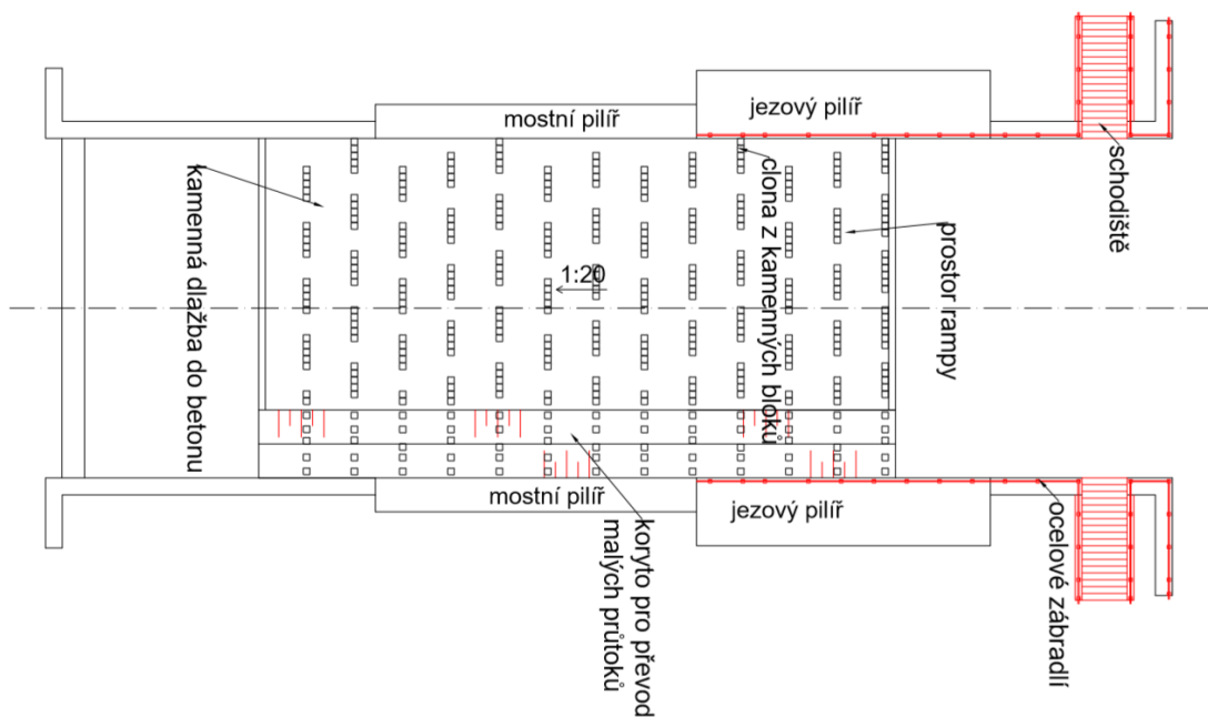
Obrázek 5.6 Půdorys migrační rampy
