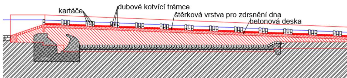
Obrázek 5.14 Podélný řez žlabovým kartáčovým rybím přechodem
