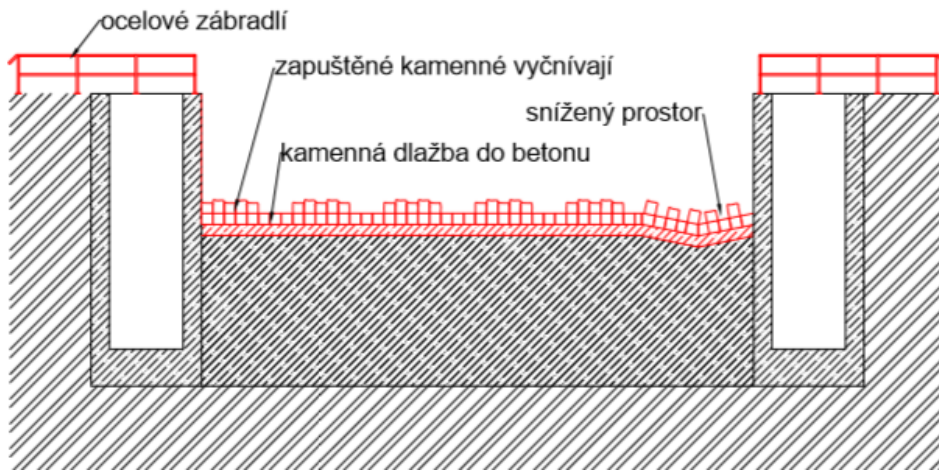
Obrázek 5.4 Příčný řez migrační rampou
