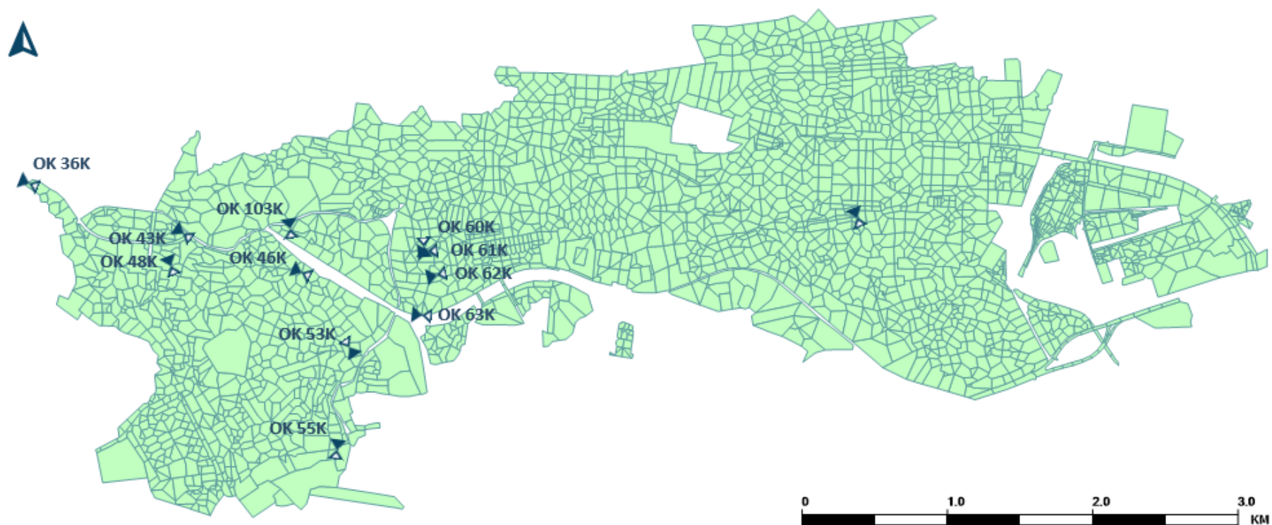
Obrázek. 30: Umístění odlehčovací komor na povodí Solidarita
