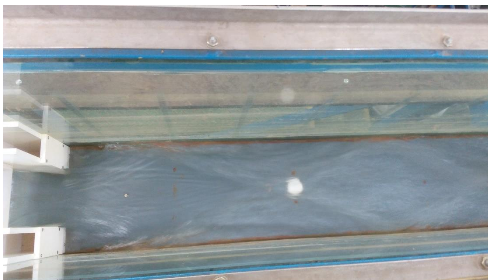
Obr. 8.1.1 Vznik příčných vln
