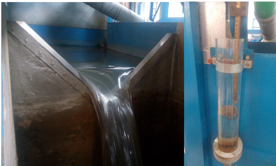
Obr. 6.2.2.2 Thomsonův měrný přeliv, Obr. 6.2.2.3 Hrotové měřítko v tlumícím válci
