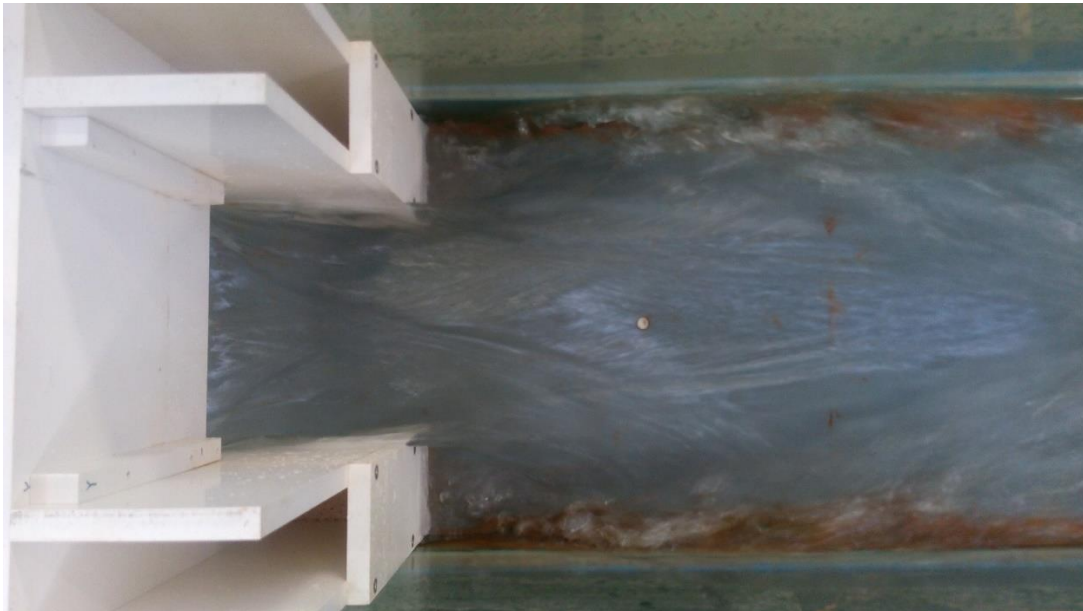
Obr. 8.4.1 Postupné rozšiřování proudu za mostním objektem
