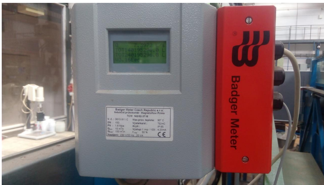
Obr. 6.2.2.1 Elektrický indukční průtokoměr
