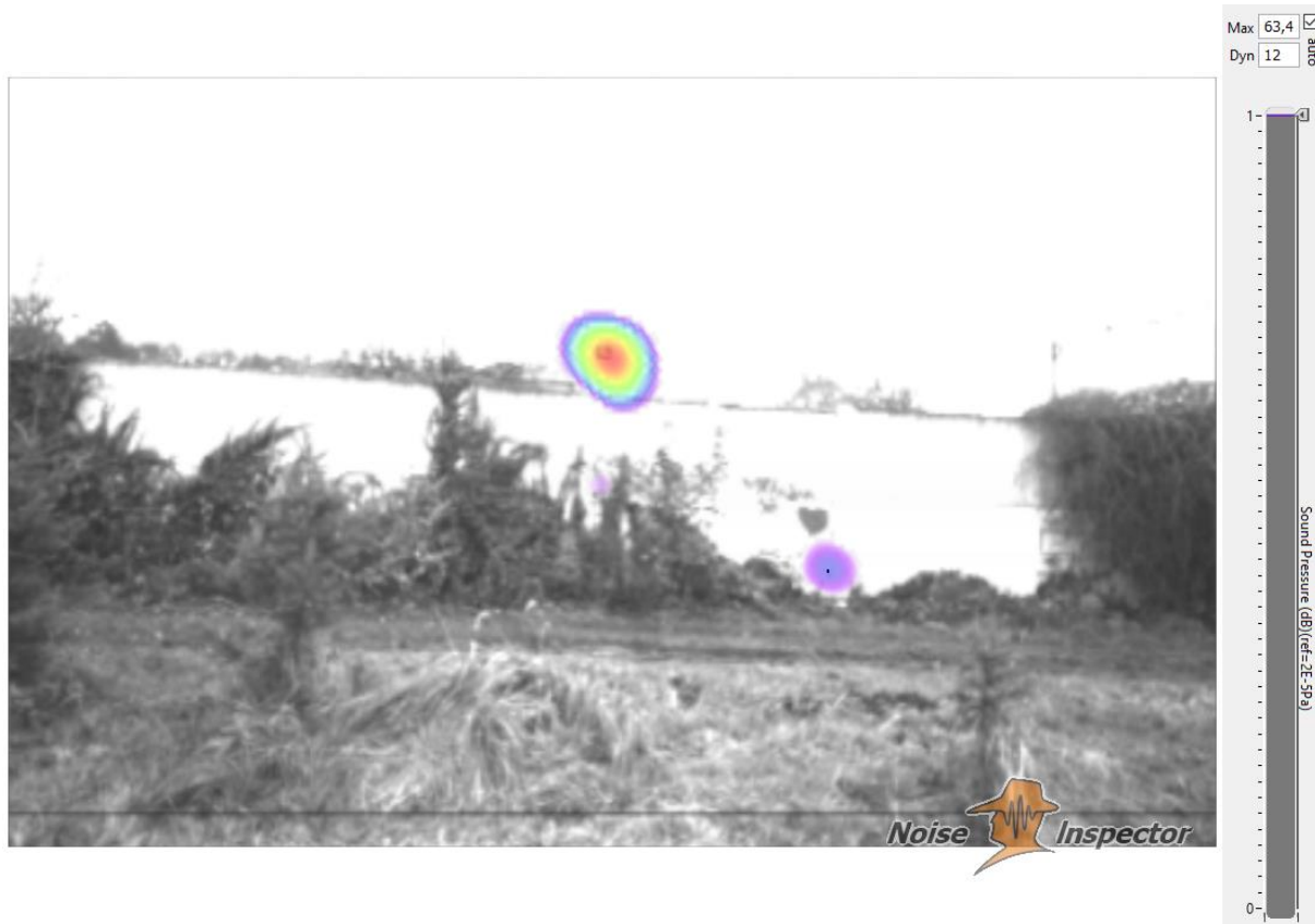
Obr. 42: 3 kHz – 4 kHz; max. hladina 63,4 dB; ve spáře 54,9 dB
