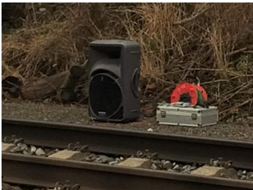
Obr. 25: Budící aparatura, zdroj zvuku, 110 dB
