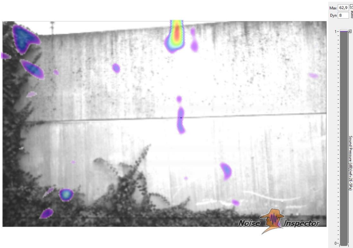
Obr. 36: 4 kHz – 5 kHz; max. hladina 62,9 dB; ve spáře 56,8 dB
