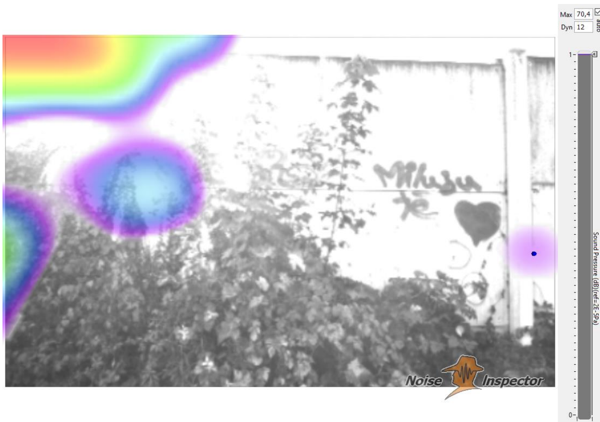
Obr. 65: 1 kHz – 2 kHz; max. hladina 70,4 dB; ve spáře (sloup) 59,8 dB
