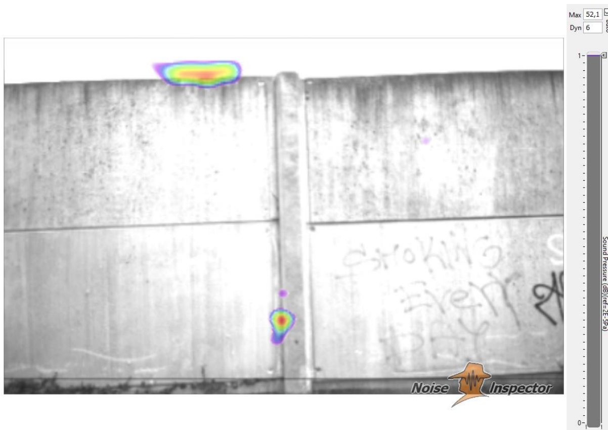
Obr. 38: 4 kHz – 5 kHz; max. hladina 52,1 dB; ve spáře 52,1 dB
