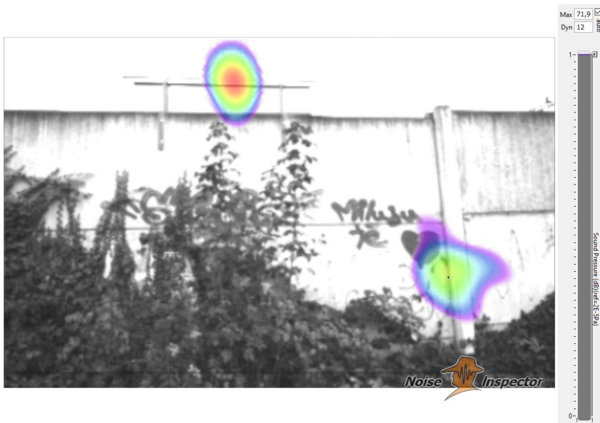
Obr. 45: 2 kHz – 3 kHz; max. hladina 71,9 dB; ve spáře 68,9 dB
