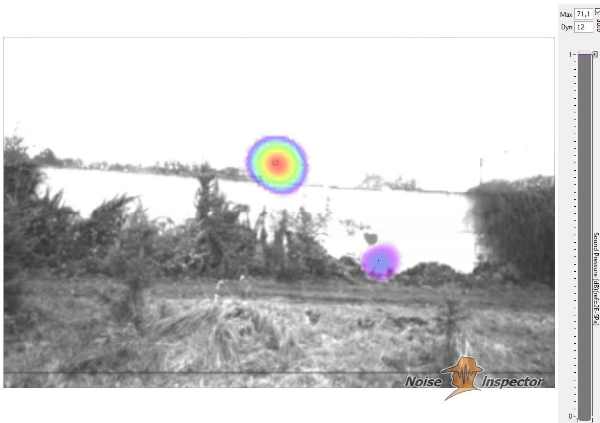
Obr. 41: 2 kHz – 3 kHz; max. hladina 71,1 dB; ve spáře 62,8 dB
