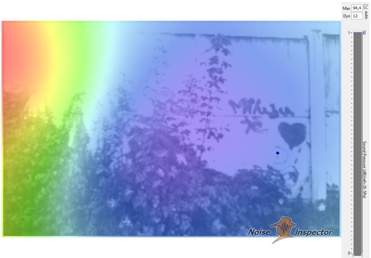
Obr. 63: 0 kHz – 1 kHz; max. hladina 94,1 dB; v místě bodu na stěně 86,2 dB
