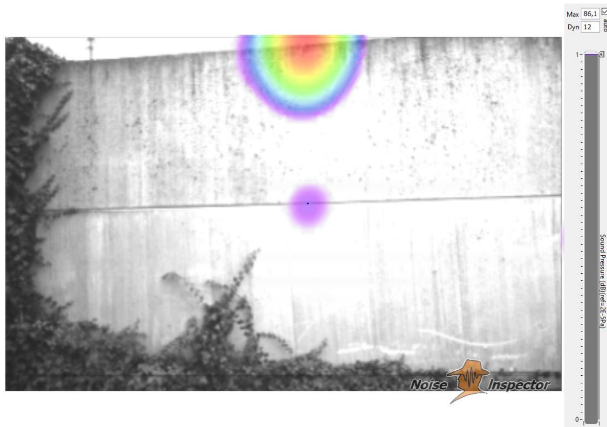
Obr. 33: 1 kHz – 2 kHz; max. hladina 86,1 dB; ve spáře 76,6 dB
