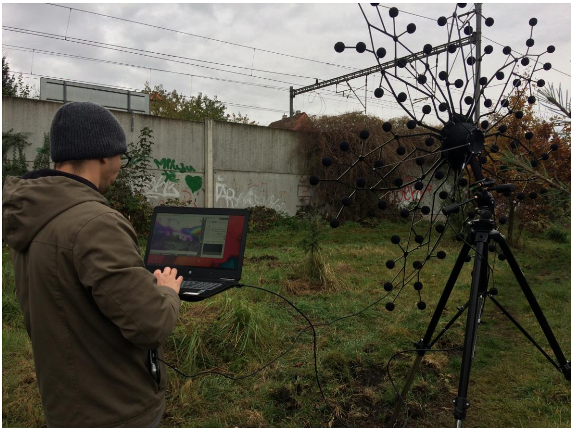
Obr. 21: Umístění akustické kamery na stanovišti
