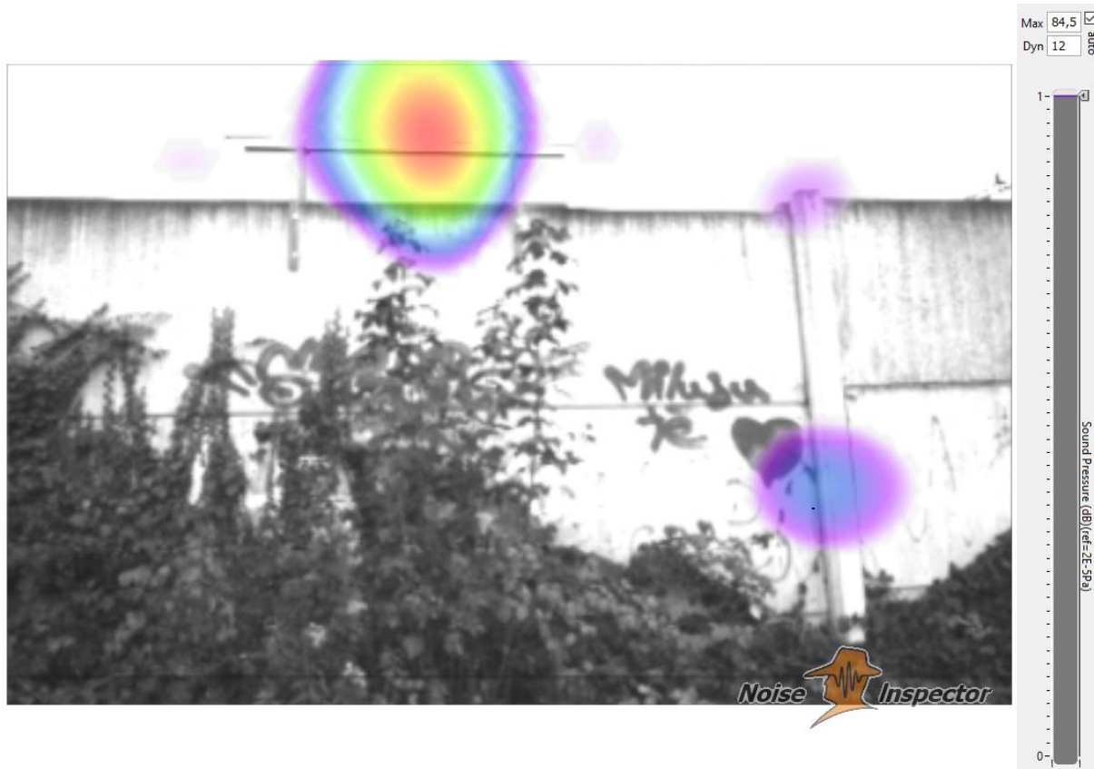
Obr. 44: 1 kHz – 2 kHz; max. hladina 84,5 dB; ve spáře 76,2 dB
