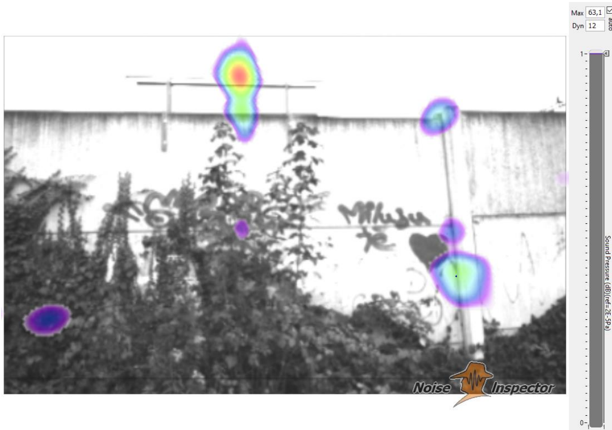
Obr. 46: 3 kHz – 4 kHz; max. hladina 63,1 dB; ve spáře 58,3 dB
