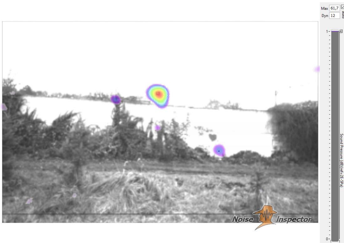
Obr. 43: 4 kHz – 5 kHz; max. hladina 61,7 dB; ve spáře 53,6 dB
